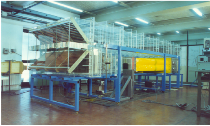
Figure 11 Politecnico di Milano Wind Tunnel 1:9 scale model
