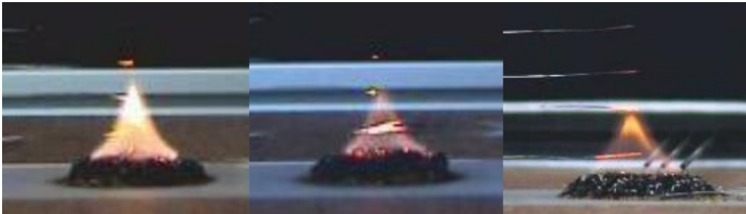
Fig. 3. Flame shape at 90 s a) Pinus halepensis b) Pinus pinaster c) Pinus laricio .
