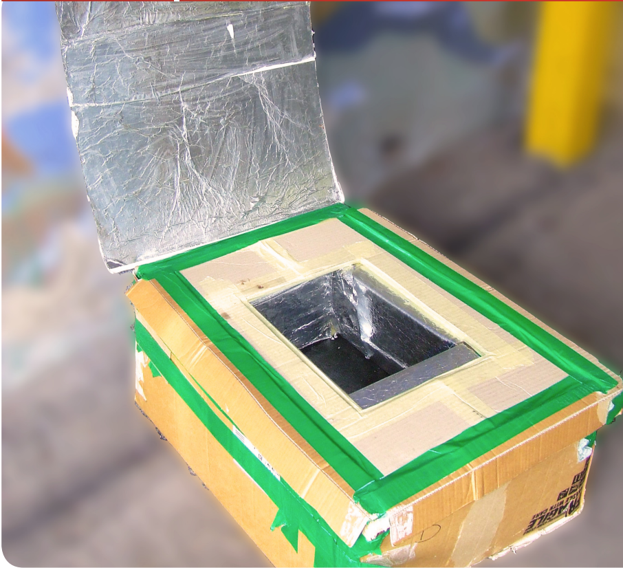
Forno solare costruito con materiali poveri a scopo dimostrativo (120° Circolo Didattico, 4 maggio 2008)
