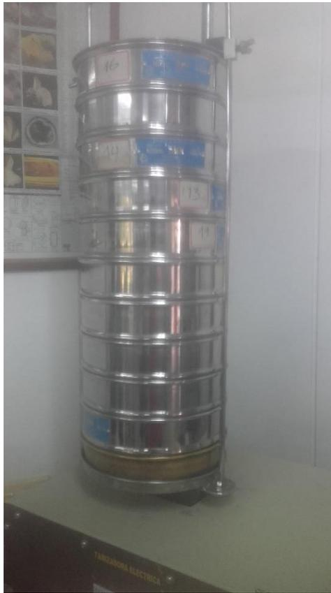
**Figura 6. Tamizadora eléctrica**
