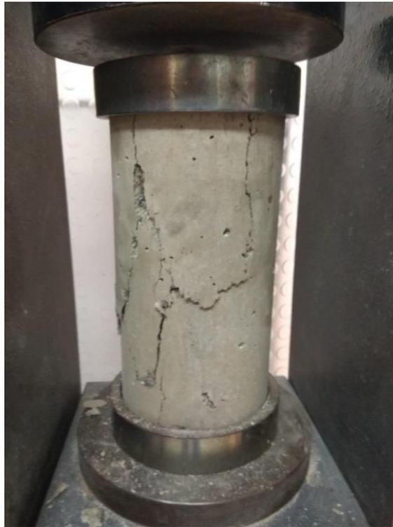
**Figura 15. Ensayo a la compresión**
