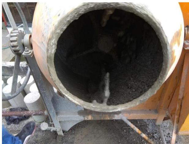
**Figura 12. Mezclado en concretadora**
