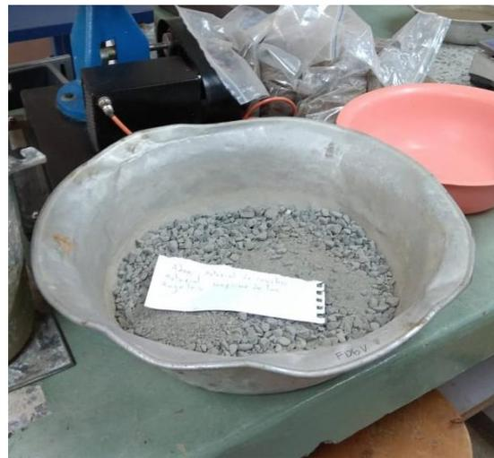
**Figura 8. Material descargado de máquina de los ángeles**
