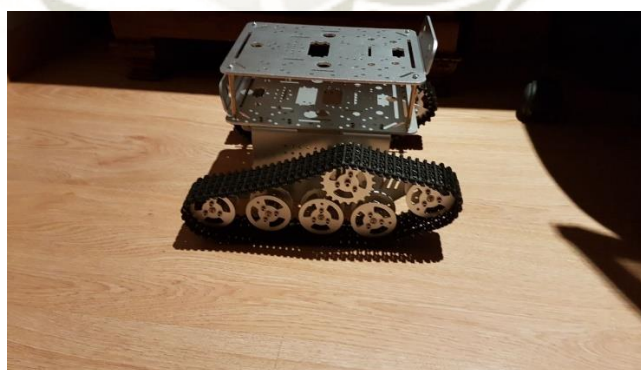
Figura 3. 35 Instalación de la pista Crawler al tanque
