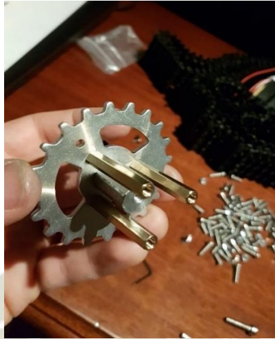
Figura 3. 28 Rueda Motriz del Tanque
