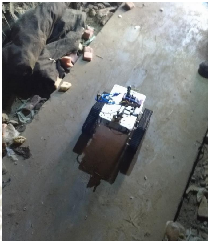
Figura 4. 8 Prueba de movimiento Escenario 2 – Terreno no asfaltado (2)
