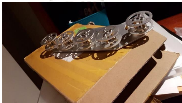
Figura 3. 32 Muestra final de la incorporación de las ruedas al Tanque
