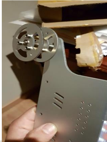
Figura 3. 30 Incorporación de una rueda al Tanque
