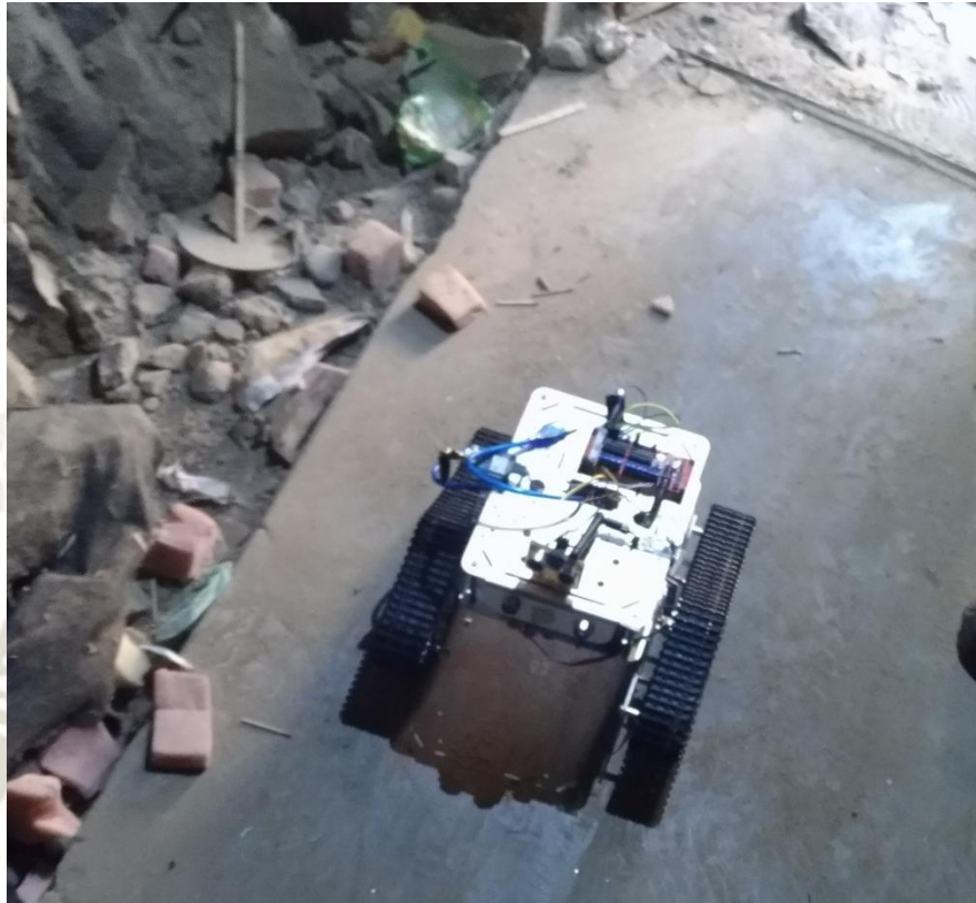
Figura 4. 7 Prueba de movimiento Escenario 2 – Terreno no asfaltado (1)
