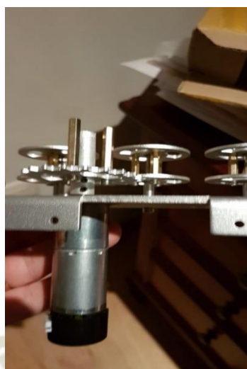
Figura 3. 33 Instalación de la Rueda Motriz
