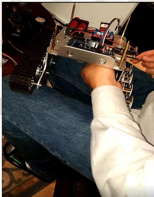
Figura 3. 54 Ajustando la rueda Motriz
