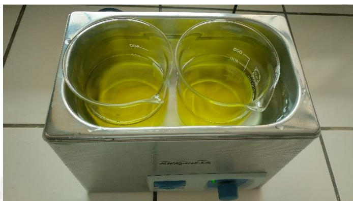
Figura 1: Desgasificación de la bebida gaseosa de descarte por sonicación
