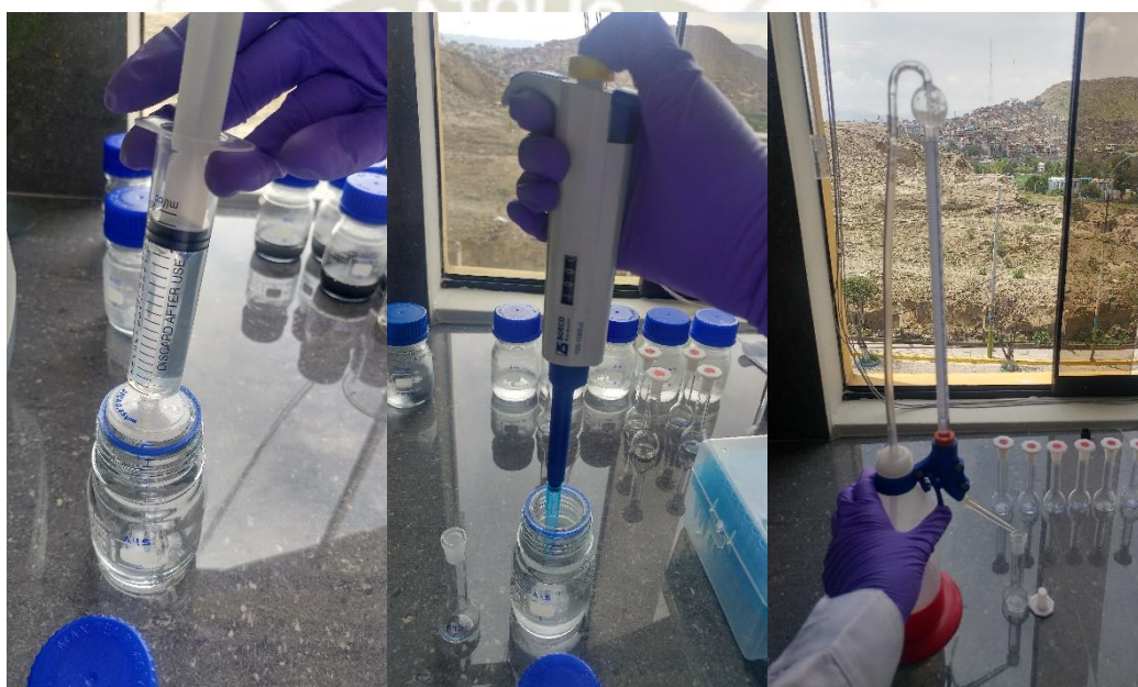
Figura 13: Microfiltración y dilución de las muestras para el método del DNS
