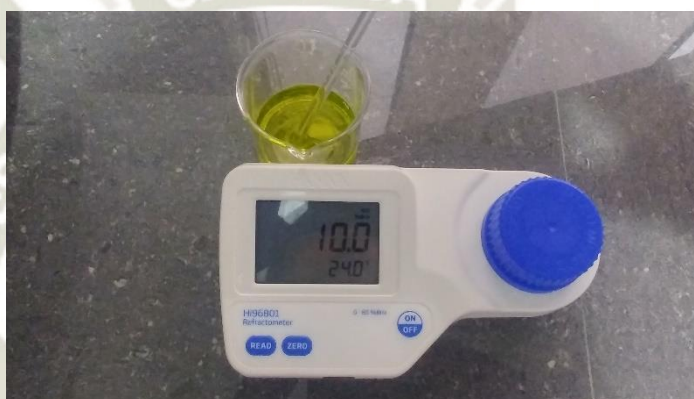
Figura 2: Determinación de los °Brix a través del refractómetro digital
