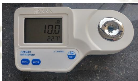
Figura 3.2: Registro del contenido de azúcares disueltos o °Brix en la bebida gaseosa amarilla
