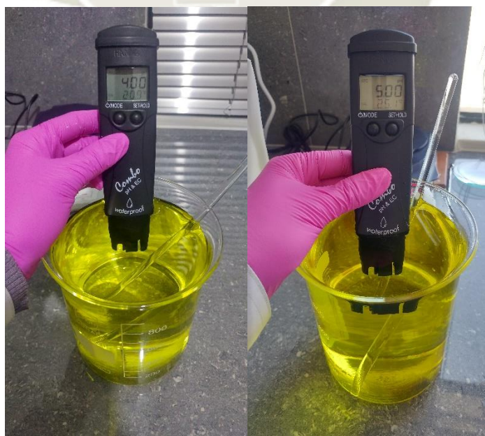
Figura 3: Determinación del pH de los tratamientos (pH 4 y pH 5)
