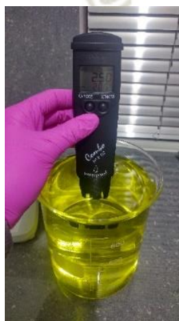
Figura 3.1: Registro del pH en la bebida la bebida gaseosa de descarte
