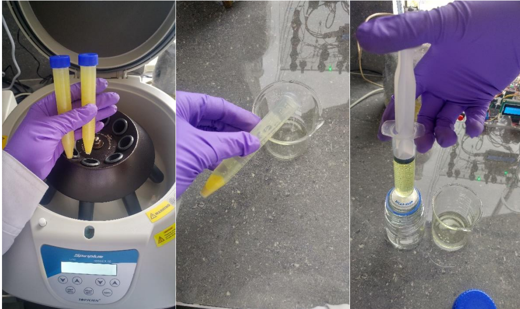
Figura 10: Centrifugación y microfiltración de las muestras de cada tratamiento
