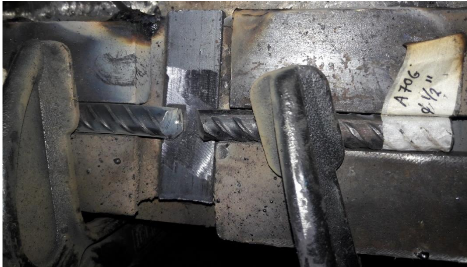
Ilustración 40. Bisel en V realizado a la barra ASTM A615 y A706 con \phi 1/2'' [55].
