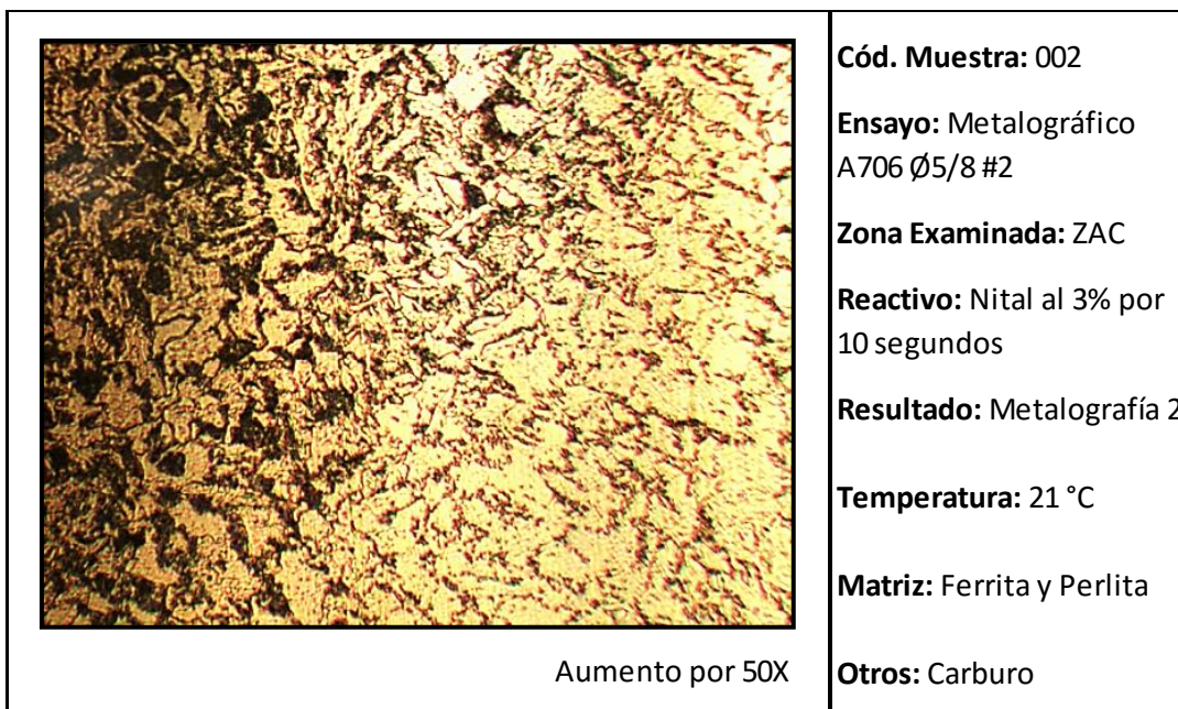
Ilustración 60. Micrografía en ZAC de Probeta #02. ASTM A706 \phi 5/8" soldadura con electrodo E8018-C3.
