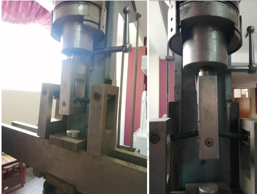
Ilustración 49. Ensayo de doblado de hierro corrugado ASTM A615 \phi 1/2" [55].
