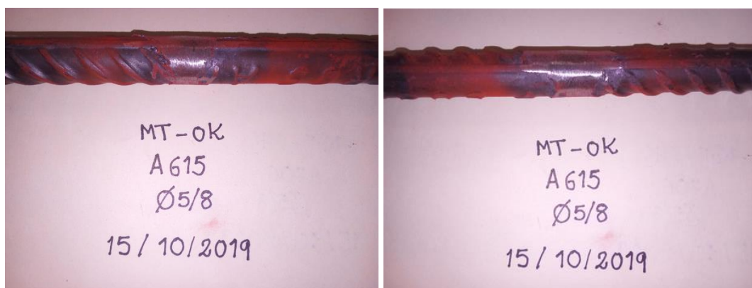
Ilustración 94. Probeta #04 – Partículas Magnéticas - ASTM A615 de 5/8" soldadura con electrodo E9018-G [55].
