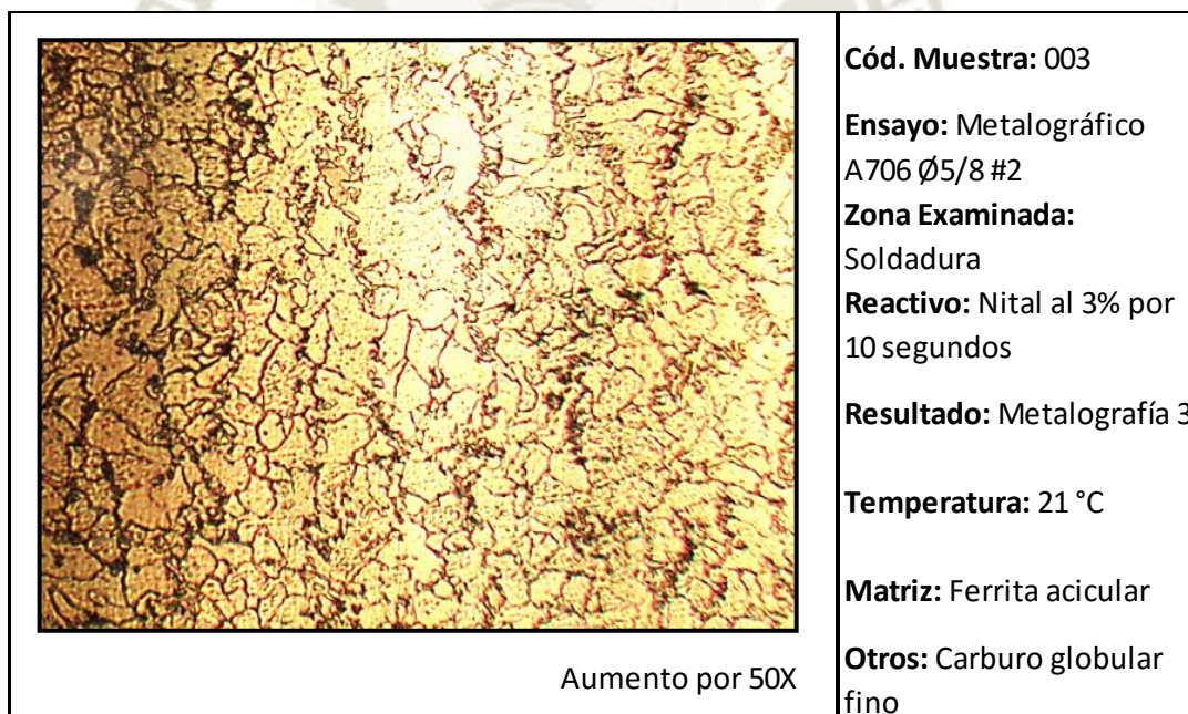
Ilustración 61. Micrografía en Soldadura de Probeta #02. ASTM A706 \phi 5/8" soldadura con electrodo E8018-C3.
