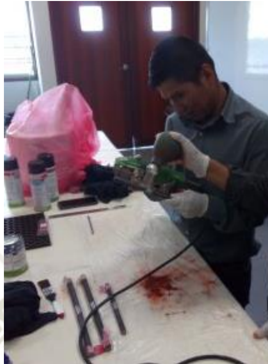
Ilustración 89. Aplicación de partículas secas en zona magnetizada de las barras de ASTM A615 y ASTM A706 de \phi 1/2" y \phi 5/8" [55].
