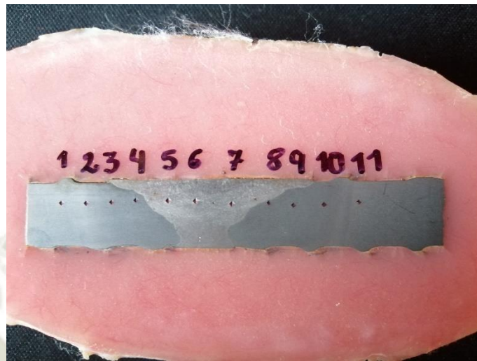
Ilustración 77. Probeta #10 – Ensayo de Dureza - ASTM A615 de \phi 1/2 " soldadura con electrodo E9018-G [55].
