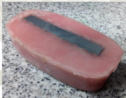
Ilustración 52. Probeta #09. ASTM A706 \phi 1/2 " soldadura con electrodo E8018-C3 [55].
