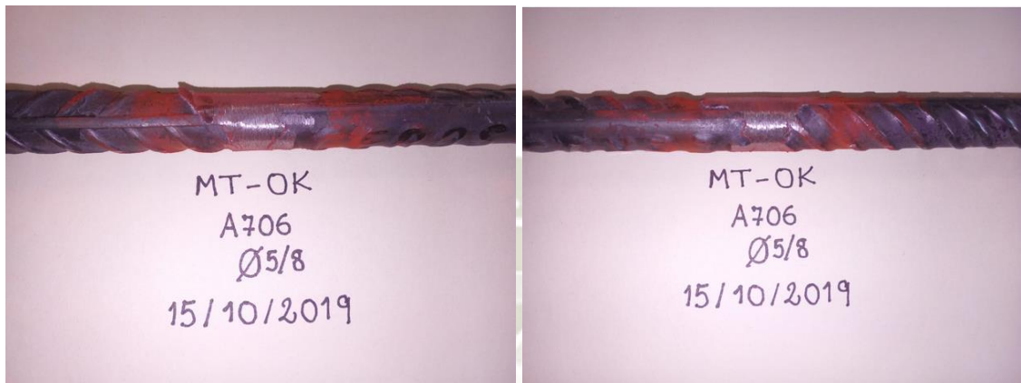
Ilustración 91. Probeta #03 – Partículas Magnéticas - ASTM A706 de 5/8" soldadura con electrodo E8018-C3 [55].
