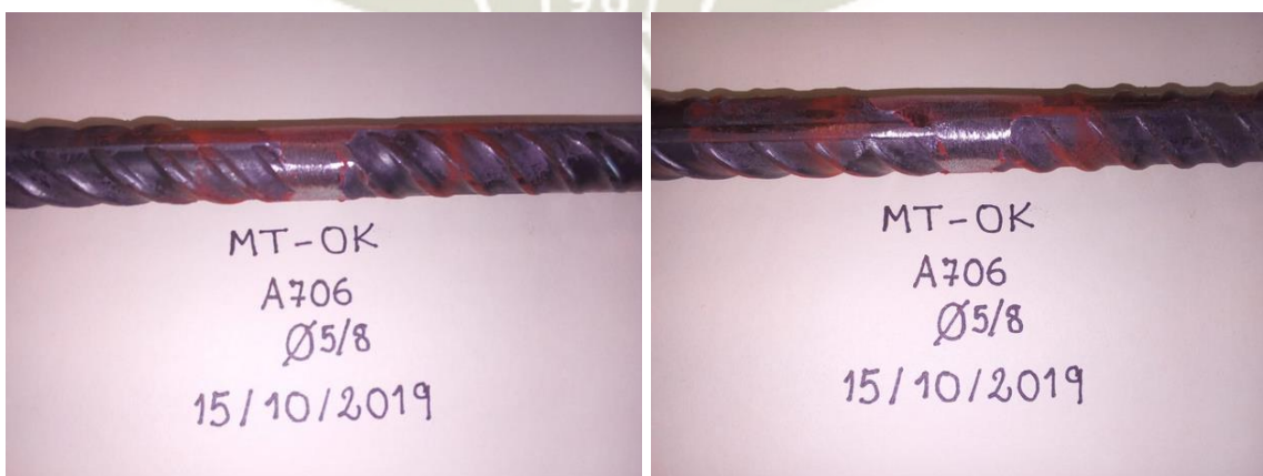
Ilustración 90. Probeta #02 – Partículas Magnéticas - ASTM A706 de 5/8" soldadura con electrodo E8018-C3 [55].
