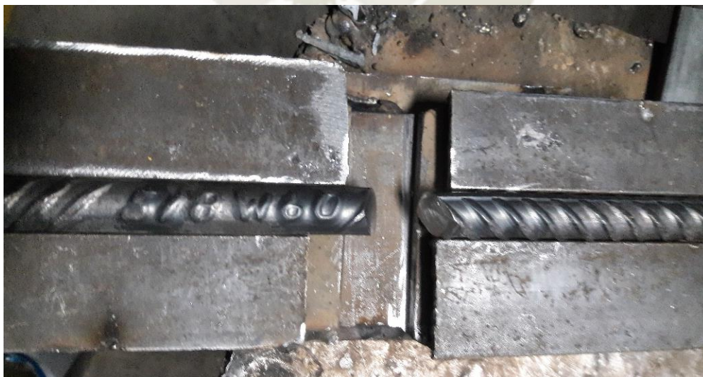
Ilustración 42. Bisel en V realizado a las barras ASTM A615 y A706 con \phi 5/8'' [55].
