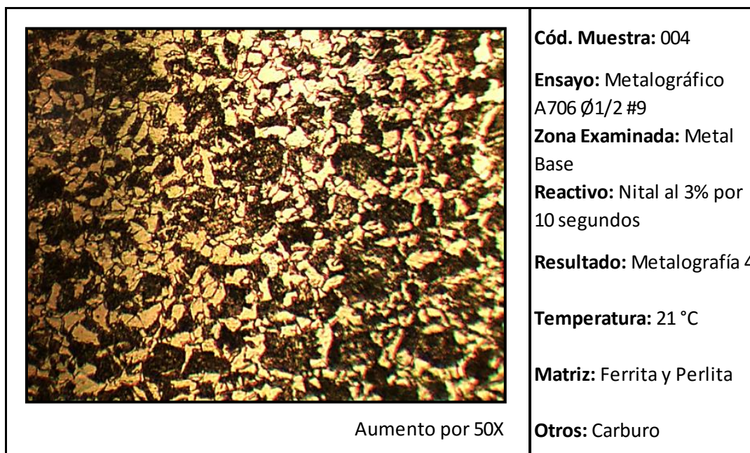
Ilustración 62. Micrografía en Metal Base de Probeta #09. ASTM A706 \phi 1/2 " soldadura con electrodo E8018-C3.
