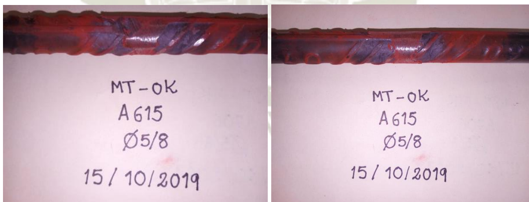
Ilustración 95. Probeta #06 – Partículas Magnéticas - ASTM A615 de 5/8" soldadura con electrodo E9018-G [55].
