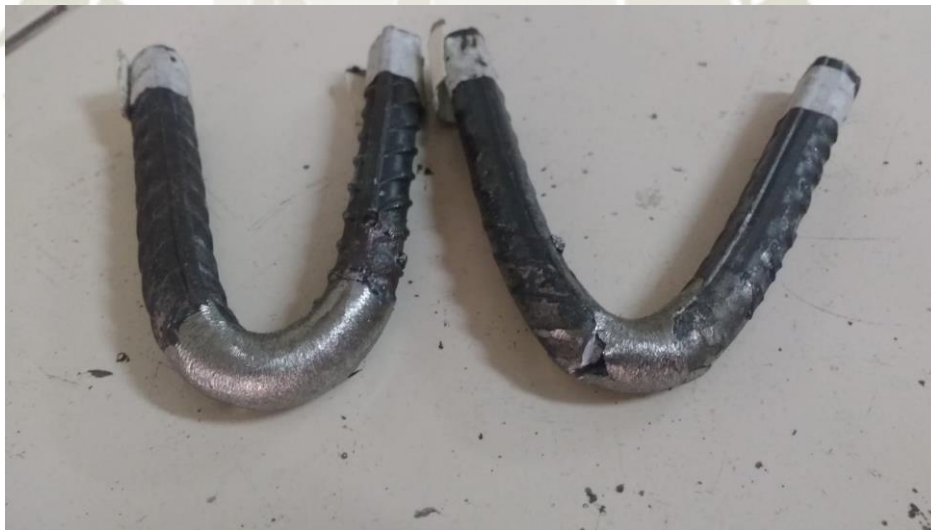
Ilustración 50. Probetas de doblado de barra \phi 1/2" de ASTM A706 y ASTM A615 [55].
