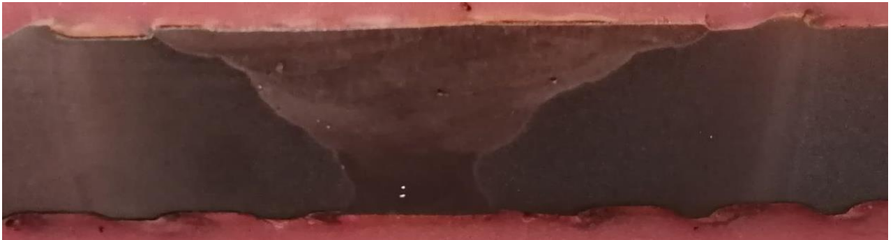
Ilustración 58. Macrografía de Probeta #10. ASTM A615 \phi 5/8 " soldadura con electrodo E9018-G [55].
