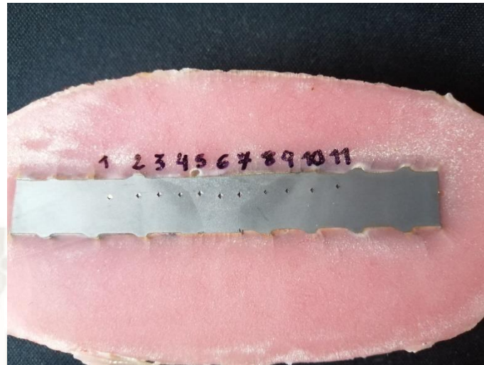
Ilustración 73. Probeta #09 – Ensayo de Dureza - ASTM A706 de \phi 1/2 " soldadura con electrodo E8018-C3 [55].
