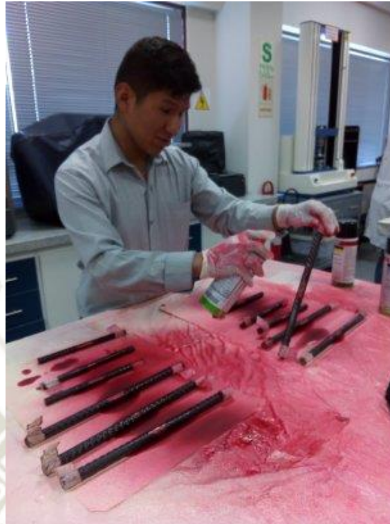
Ilustración 80. Aplicación del penetrante a las barras de ASTM A615 y ASTM A706 de \phi 1/2" y \phi 5/8" [55].
