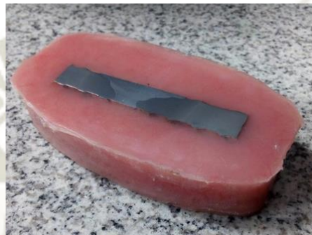
Ilustración 54. Probeta #04. ASTM A615 \phi 1/2" soldadura con electrodo E9018-G [55].
