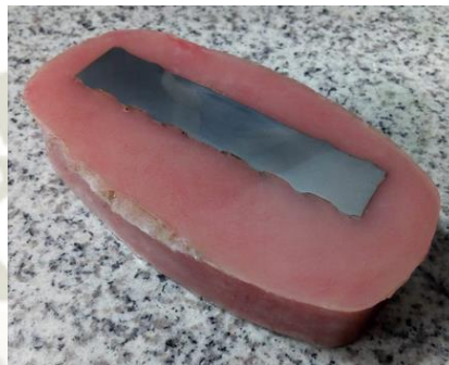
Ilustración 51. Probeta #02. ASTM A706 \phi 5/8 " soldadura con electrodo E8018-C3 [55].
