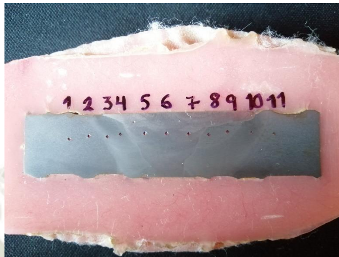
Ilustración 75. Probeta #04 – Ensayo de Dureza - ASTM A615 de \phi 5/8 " soldadura con electrodo E9018-G [55].
