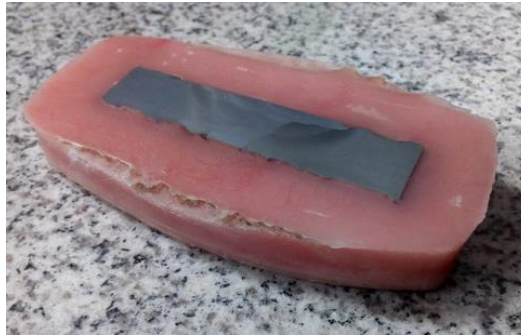
Ilustración 53. Probeta #04. ASTM A615 \phi 5/8" soldadura con electrodo E9018-G [55].
