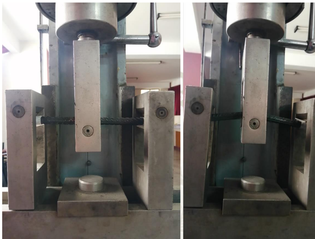
Ilustración 48. Ensayo de doblado de fierro corrugado ASTM A706 \phi 1/2" [55].
