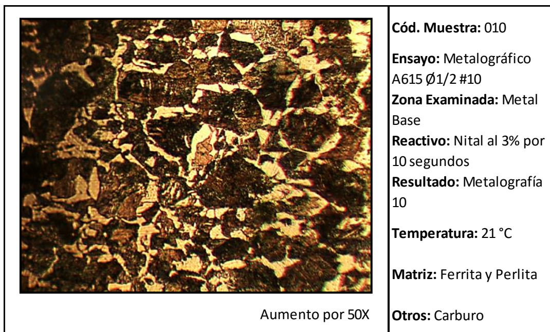
Ilustración 68. Micrografía en Metal Base de Probeta #10. ASTM A615 \phi 1/2 " soldadura con electrodo E9018-G.
