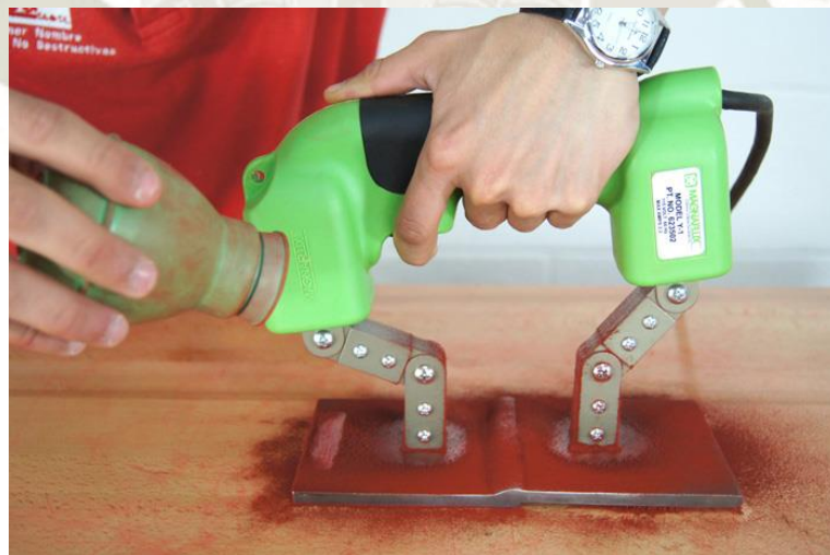
Ilustración 28. Ensayo de partículas magnéticas [53].
