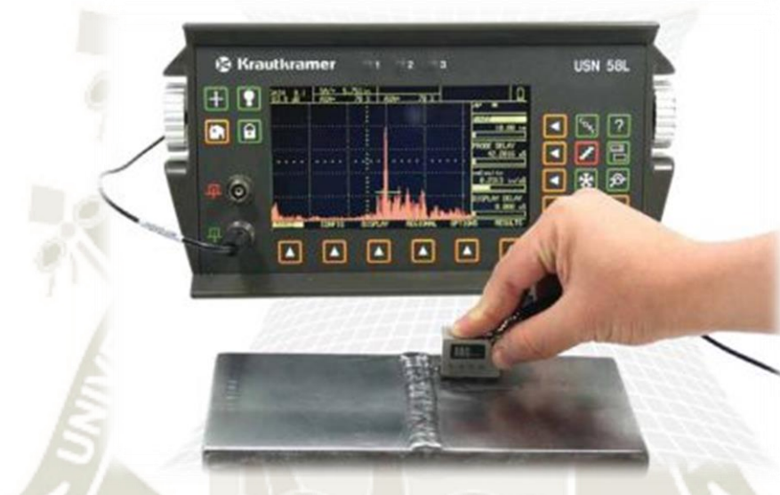
Ilustración 29. Diagrama del ensayo por ultrasonido [54].
