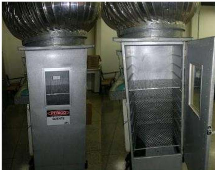
**Figura 4.2** – Desidratador misto, do tipo eólico solar/convencional
