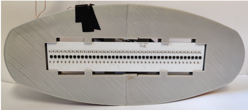
Bild 3.24: Sensorprototyp mit ovaler Spule und Hallarrayplatine mit 40 Hallelementen
