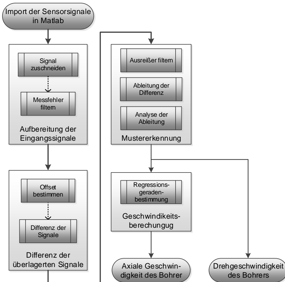
Bild 23 Ablaufdiagramm der Auswertung von Axial- und Drehgeschwindigkeit(Wacker, 2018) 18
