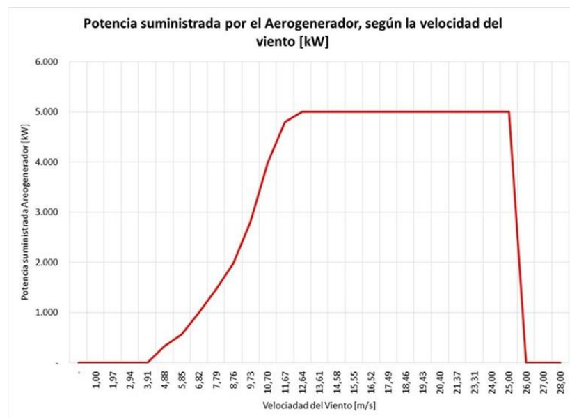
Figura 12. Capacidad del aerogenerador según la velocidad del viento. Tomado de: Fuente: (AREVA, 2019)
