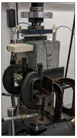
Figure 98: Concrete-TP Stud Testing Setup
