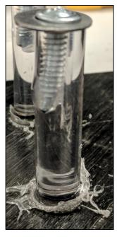
Figure 97: Neat-Resin Shear Stud
