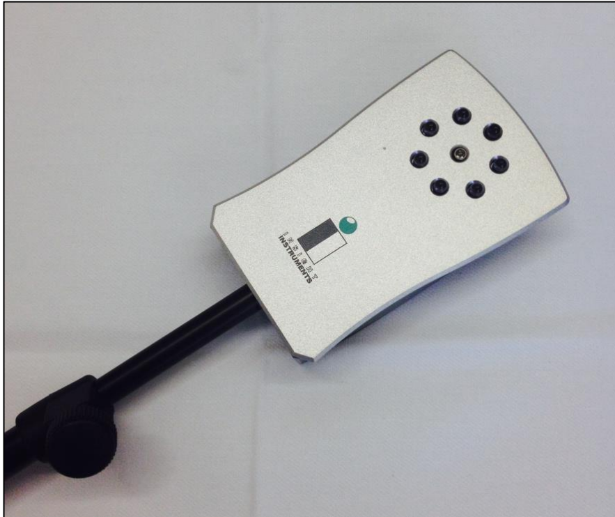
Abb. 8: Infrarotsensor. Aufzeichnung der Atembewegungen
