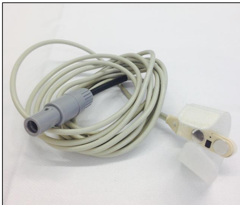
Abb. 7: Multisensor. Ableitung des Hautleitwerts, der Hauttemperatur und Pulsfrequenz
