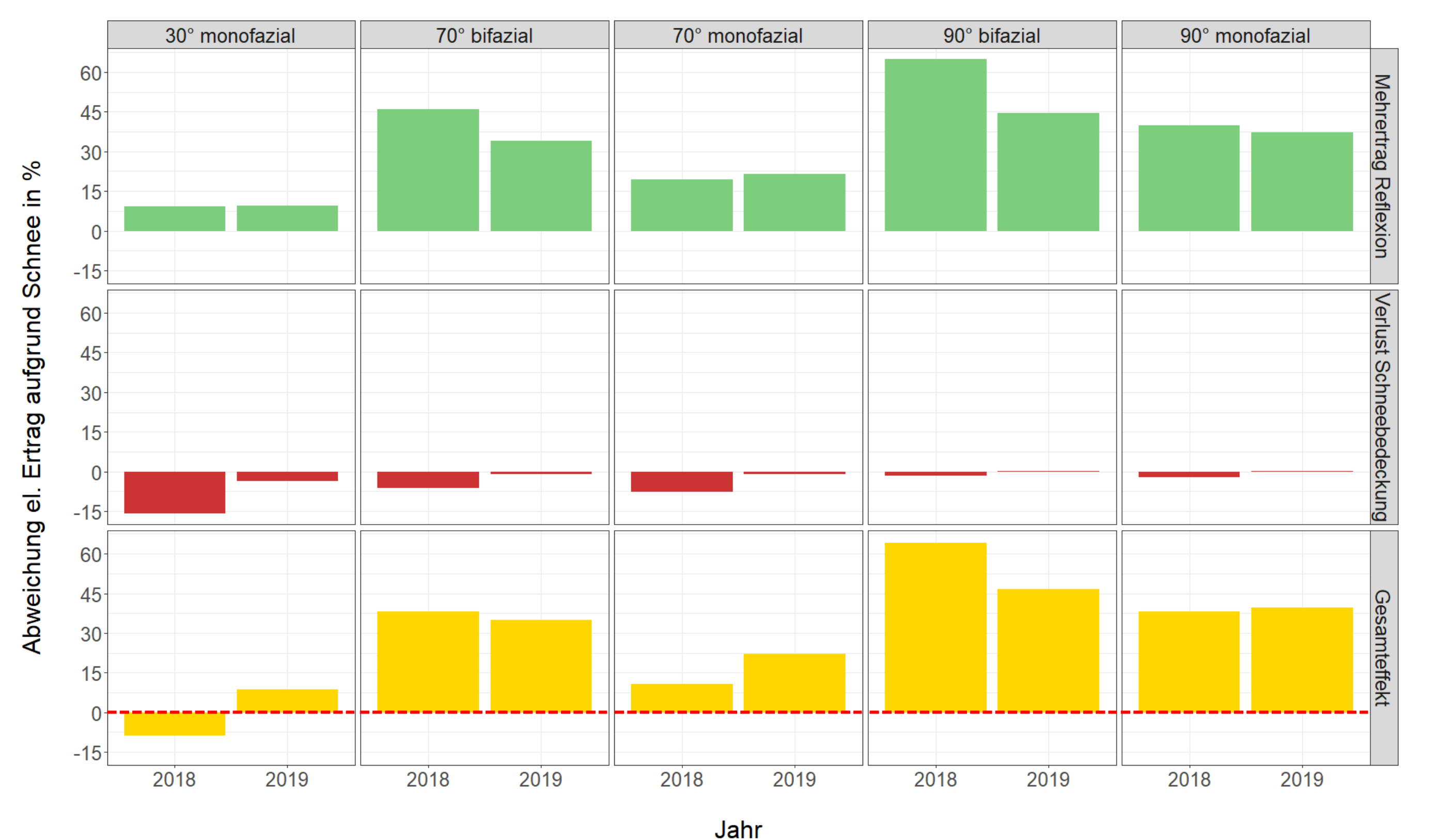
Abb. 3: Einfluss von Schnee auf den el. Ertrag aufgrund höherer Einstrahlung durch Reflexion (oben), Schneebedeckung von Modulen (Mitte) und als Gesamteffekt beider Einflüsse (unten). Abweichungen schneebedeckt (05.03. bis 04.05) gegenüber schneefrei (08.09. bis 08.10). Mehrertrag normiert pro kWh horizontaler Globalstrahlung und Modultemperatur = 25 °C.
