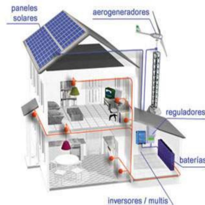
EN CASO DE SER NECESARIO PARA COMPLEMENTAR LA PRODUCCION DE ELECTRICIDAD O EL BOMBEO DE AGUA POTABLE SE PRETENDE LA INTEGRACION DEL SISTEMA DE AEROGENERADORES, CREANDO UN SISTEMA HIBRIDO DE FOTOVOLTAICOS Y AEROGENERADORES.
