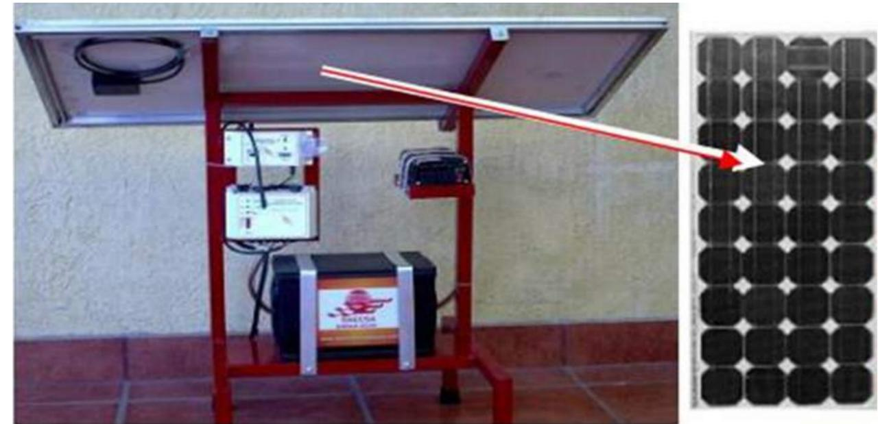
SE DENOMINA PLANTA DE ENERGIA ELECTRICA SOLAR A LA INTERCONEXION DE DIVERSOS DISPOSITIVOS TENDIENTES A TRANSFORMAR LA ENERGIA SOLAR EN ELECTRICIDAD. TAMBIEN LLAMADOS SISTEMAS FOTOVOLTAICOS; GENERALMENTE ESTAN COMPUESTOS POR LOS SIGUIENTES DISPOSITIVOS:
