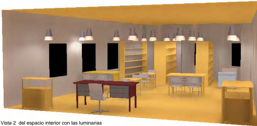
Vista 2 del espacio interior con las luminarias fluorescentes compactas
