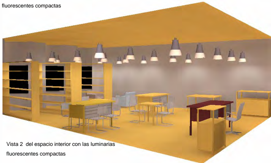
Vista 2 del espacio interior con las luminarias fluorescentes compactas
