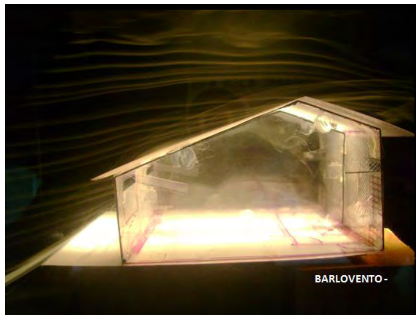
IMAGEN 6. Se observa como el efecto de turbulencia dentro se ah solucionado, evitando así problemas serios a futuro.
