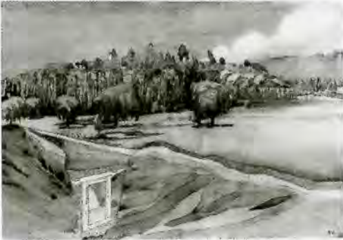
Almoloya del Río. Perspectiva que muestra el proyecto de las obras para la captación de agua de los manantiales a través de canales rectangulares de concreto. Obras para la provisión de agua potable, 1951.
