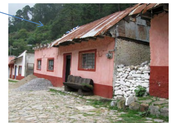
Los muros son de adobe con aplanado de yeso por los dos lados y pintura a la cal (preferentemente de colores cálidos).
