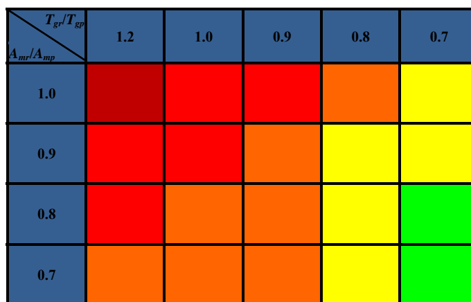
Figura 4.8 Diagrama de color para representar la influencia de los parámetros T_{gr}/T_{gp} y A_{mr}/A_{mp} en la respuesta de los sistemas estudiados
