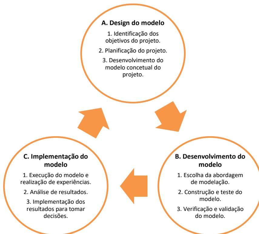
Figura 9 – Principais fases e etapas de um processo de simulação (adaptado de (Fowler & Rose, 2004))
