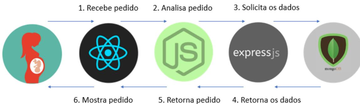
**Figura 3** - Representação esquemática da arquitetura MERN *stack*, adaptado de [40].
