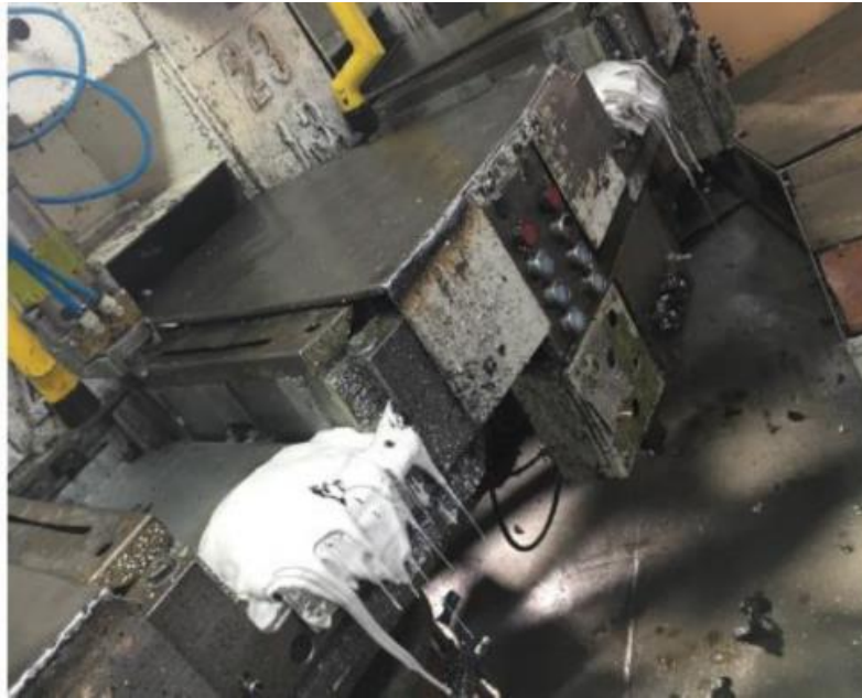
Figura 36 - Purga em dois postos da máquina 3
