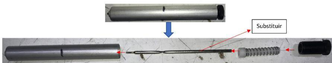
Figura 34 – Caneta montada acima e caneta desmontada em baixo
