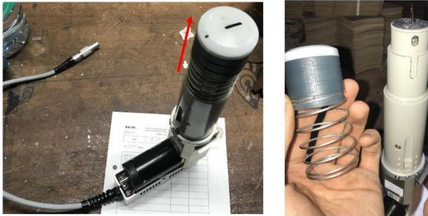
Figura 15 - Remoção da peça de proteção da lâmina
