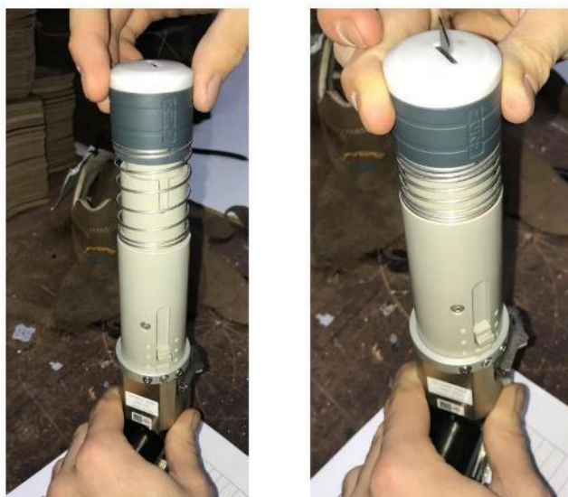
Figura 18 - Inserção da peça de proteção da lâmina na cabeça de corte
