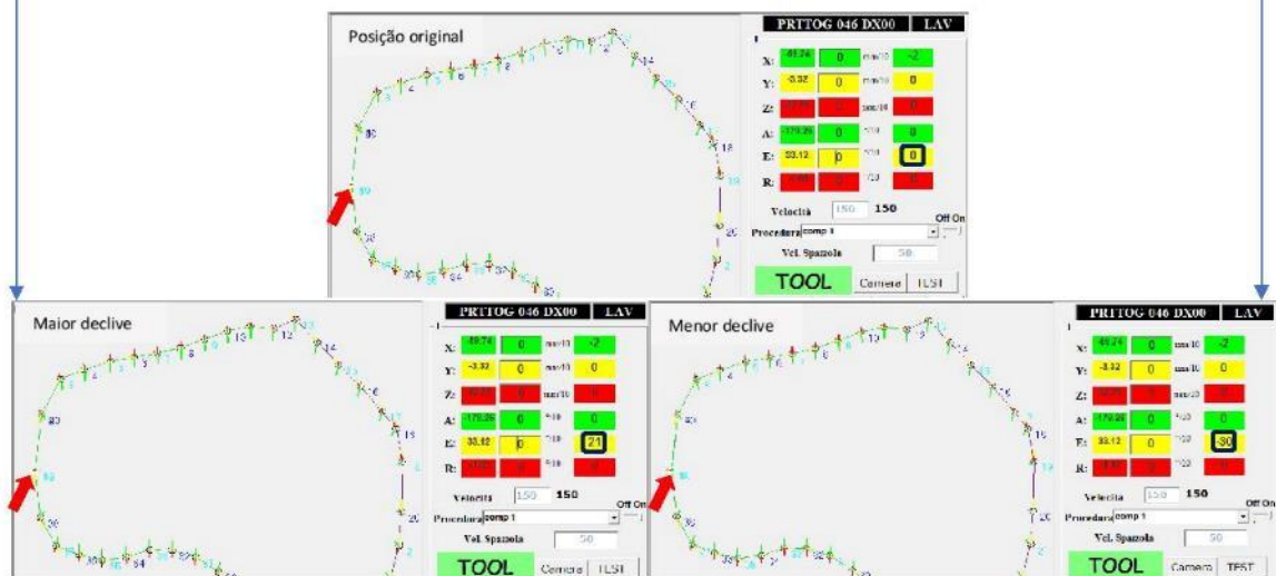
Figura 14 - Imagem superior: ponto na posição inicial (0); Imagem inferior esquerda: braço do robot com maior declive (21); Imagem inferior direita: braço do robot com menor declive (-30)
