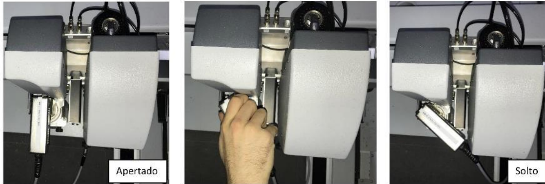
Figura 13 - Como apertar peça do topo da cabeça de corte
