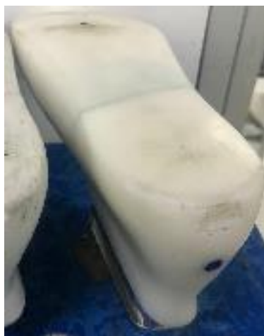
Figura 68 - Forma do tamanho 42 com chip e tampo em plástico azul
