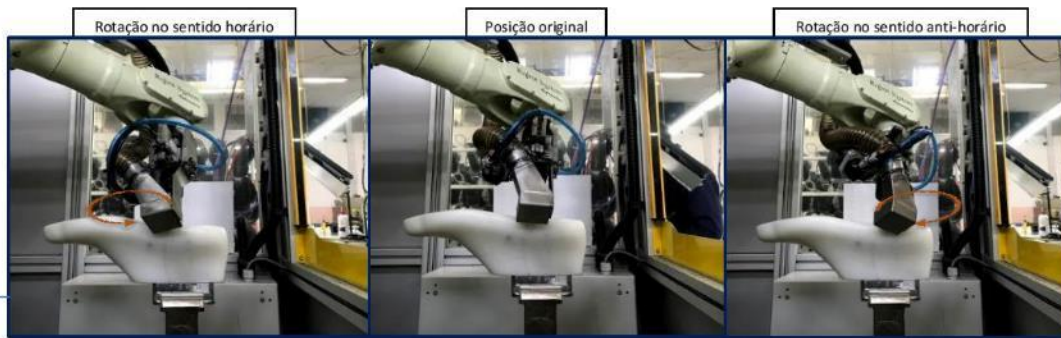
Figura 15 - Esquerda: carda fixa e com rotação horária; Centro: carda na posição inicial; Direita: carda fixa e com rotação anti-horário
