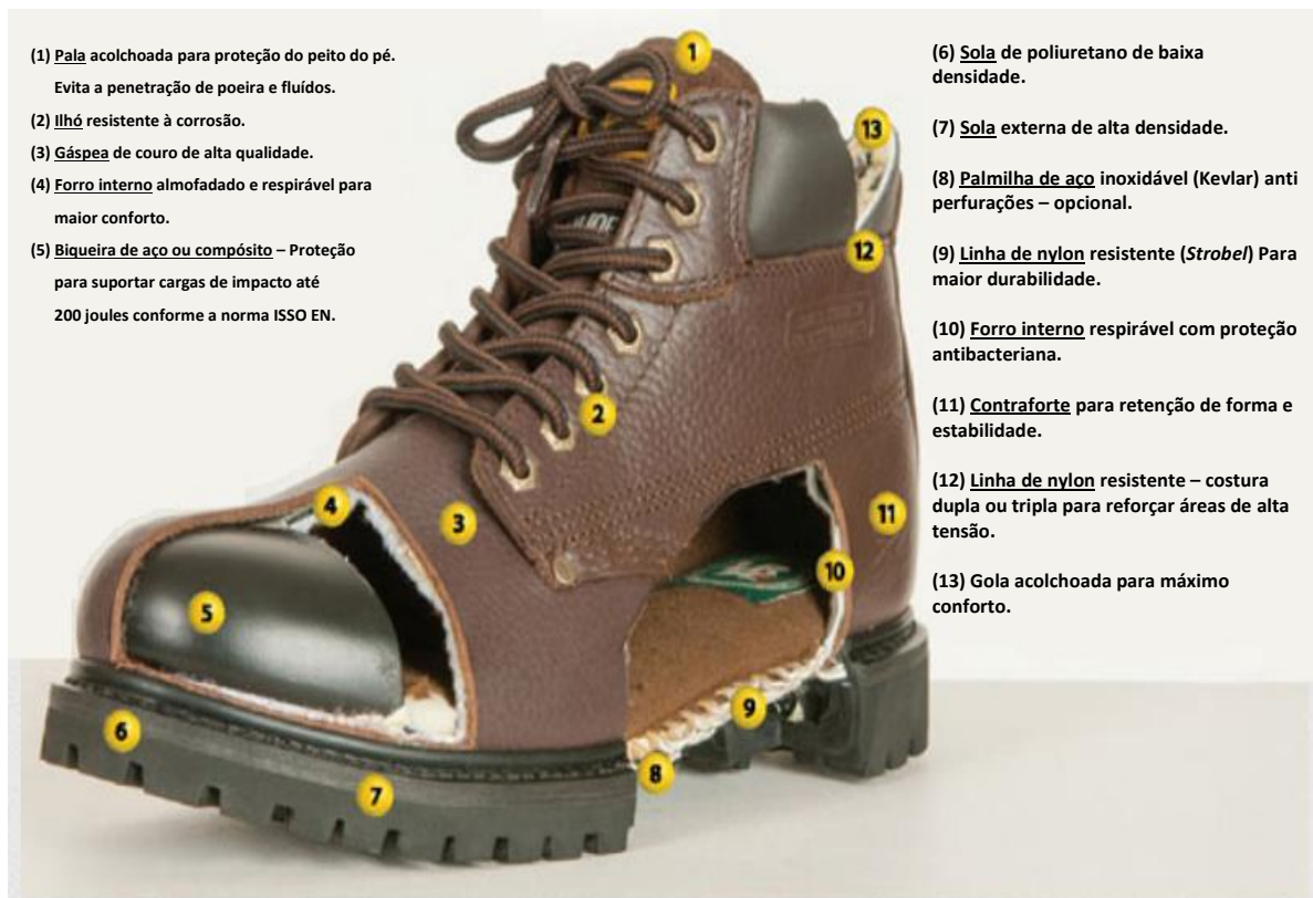
Figura 15 – Constituição de um calçado de segurança
