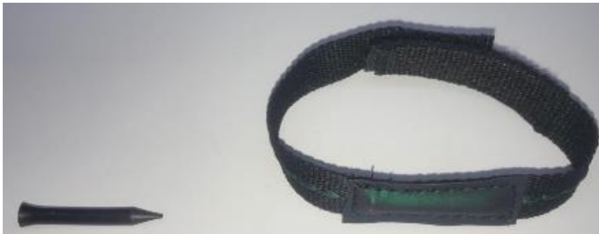
Figura 77 - Chip Rfid e Pulseira com chip
