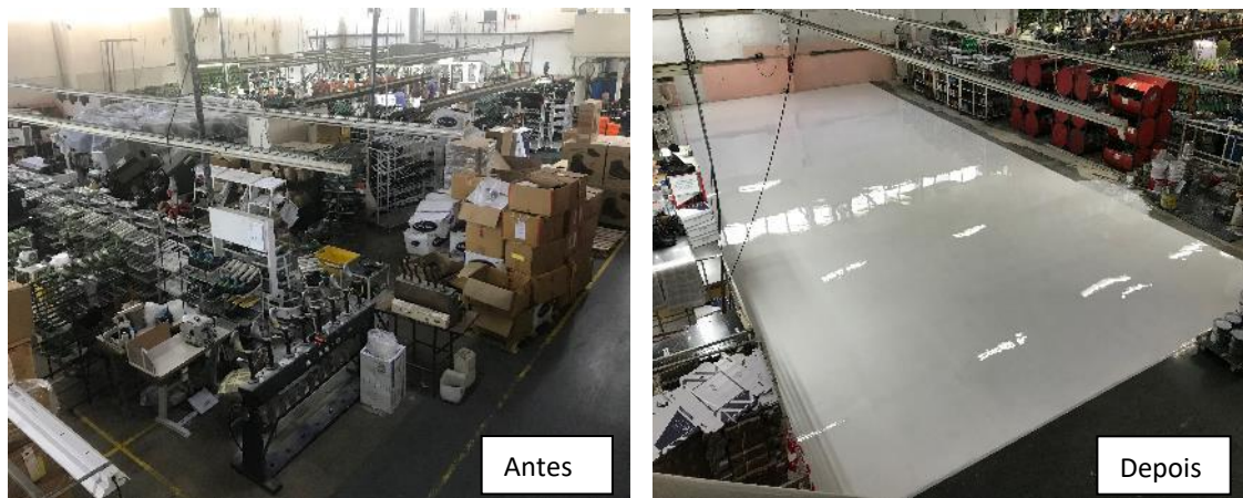
Figura 87 - Espaço da máquina 5 antes e depois da remoção do equipamento inativo - Seiri
