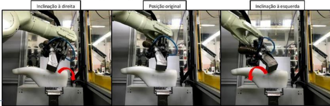
Figura 11 - Esquerda: carda com inclinação à direita; Centro: carda na posição inicial; Direita: carda com inclinação à esquerda
