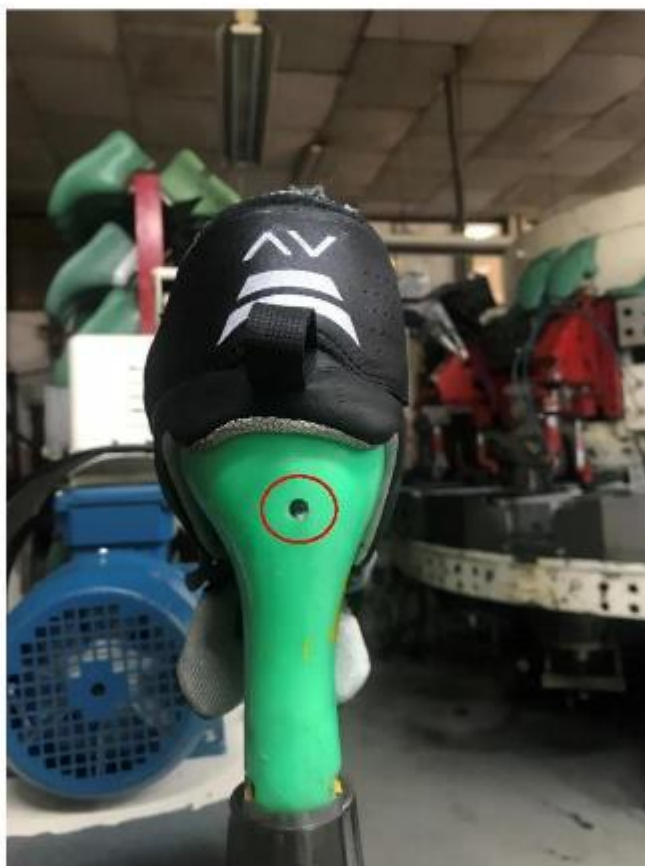
Figura 1 - forma com ship alocado
