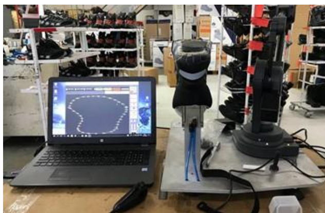
Figura 69 – MicroScribe e software de programação dos modelos no robot
