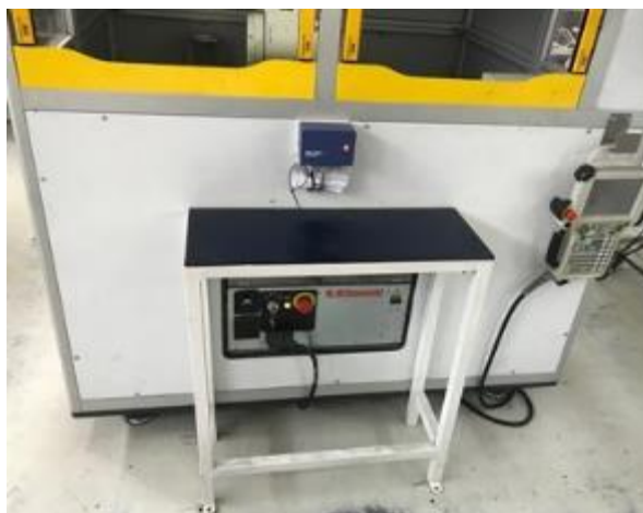
Figura 70 - Mesa de apoio e proteção dos botões do robot
