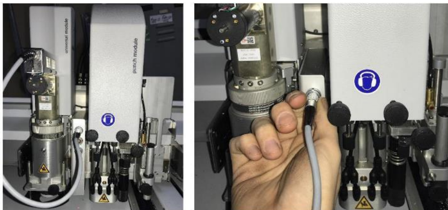
Figura 12 - Como desligar o cabo da cabeça de corte
