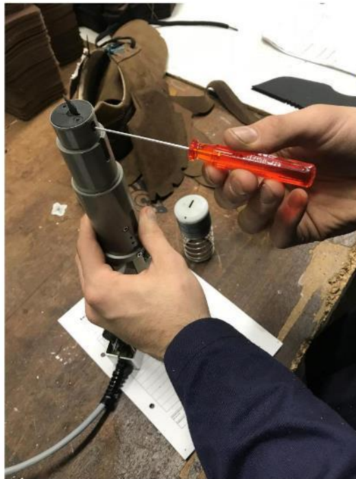
Figura 16 - Como desapertar a lâmina para a substituição da mesma
