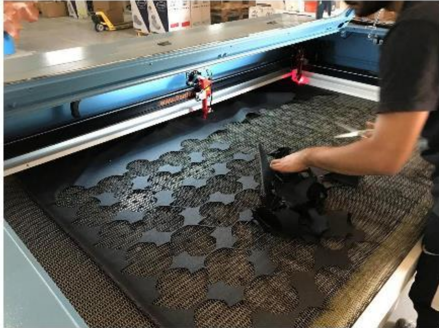
Figura 14 - Recolha das peças cortadas e sobras de material
