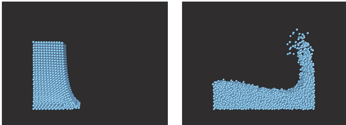
図 1.1: SPH 法による液体シミュレーション
