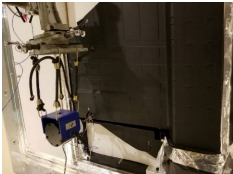
Figure 4-12 Pot vibrant installé dans la chambre réverbérante sur le point d'ancrage #4
