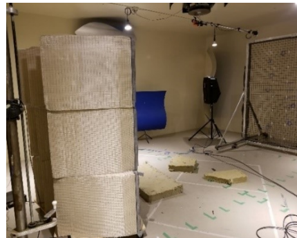
Figure 4-13 Dièdres absorbants placés dans la chambre réverbérante
