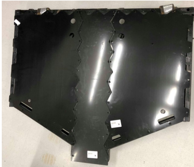
Figure 5-1 Système de la double paroi du véhicule
