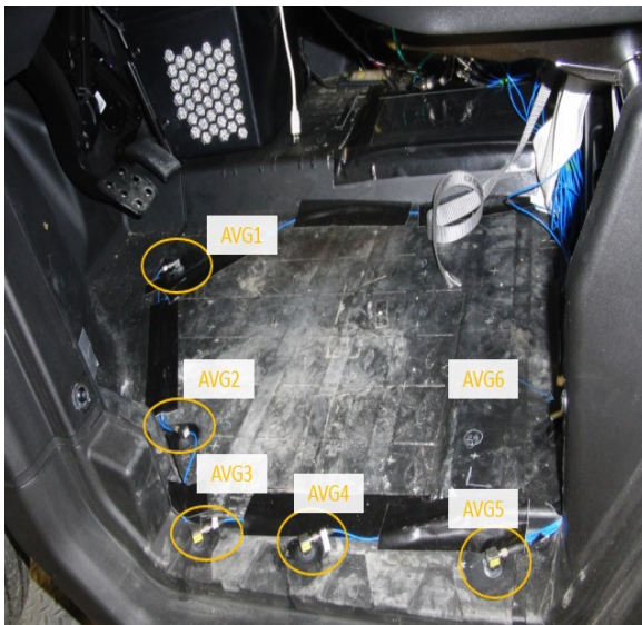
Figure 3-21 Mesure des accélérations réelles (côté conducteur)
