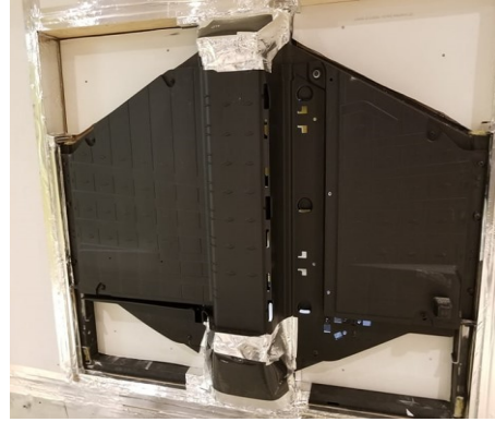
Figure 4-7 Montage du système simple paroi (coté réverbérante)
