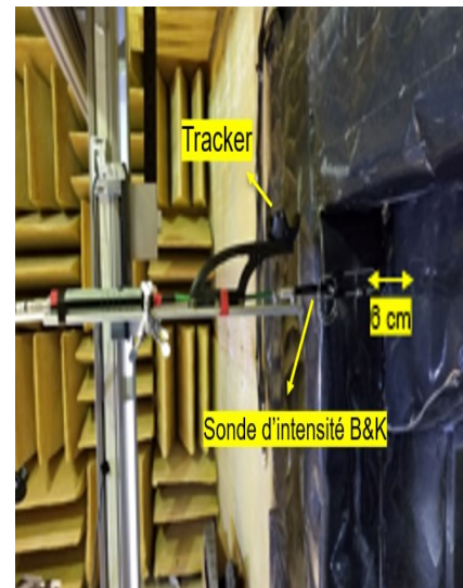
Figure 4-9 Mise en place de la sonde d'intensité sur le robot
