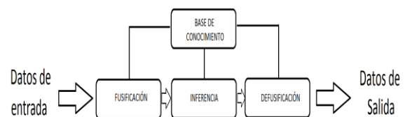
Figura 1. Adaptado de Gómez (2005). Estructura de un modelo difuso
