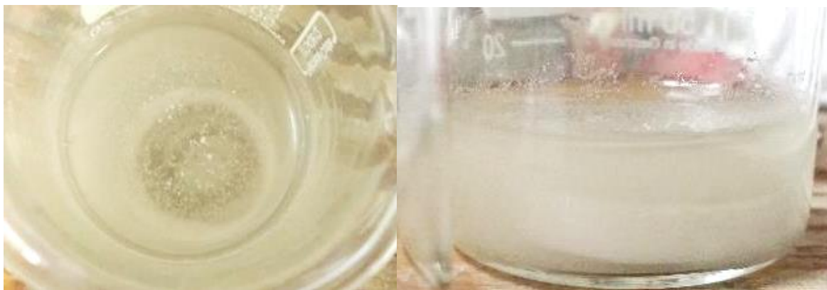
Figura 42 apariencia del coloide después de 30 minutos de ablación
