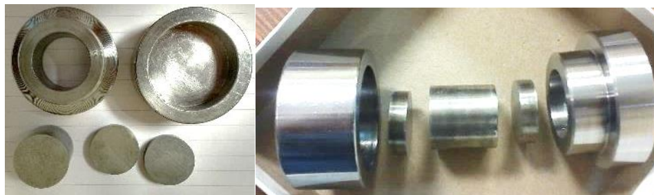
Figura 8. Troquel usado en la compactación del polvo.
