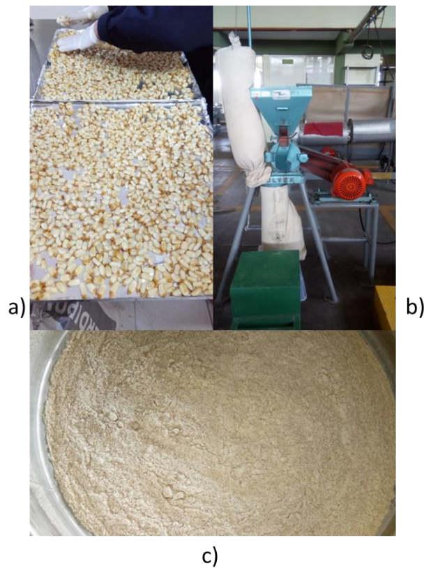
Ilustración 2. Secado y molido del grano nixtamalizado. a) Secado del grano en charolas; b) Molino para grano; c) Harina de maíz nixtamalizado
