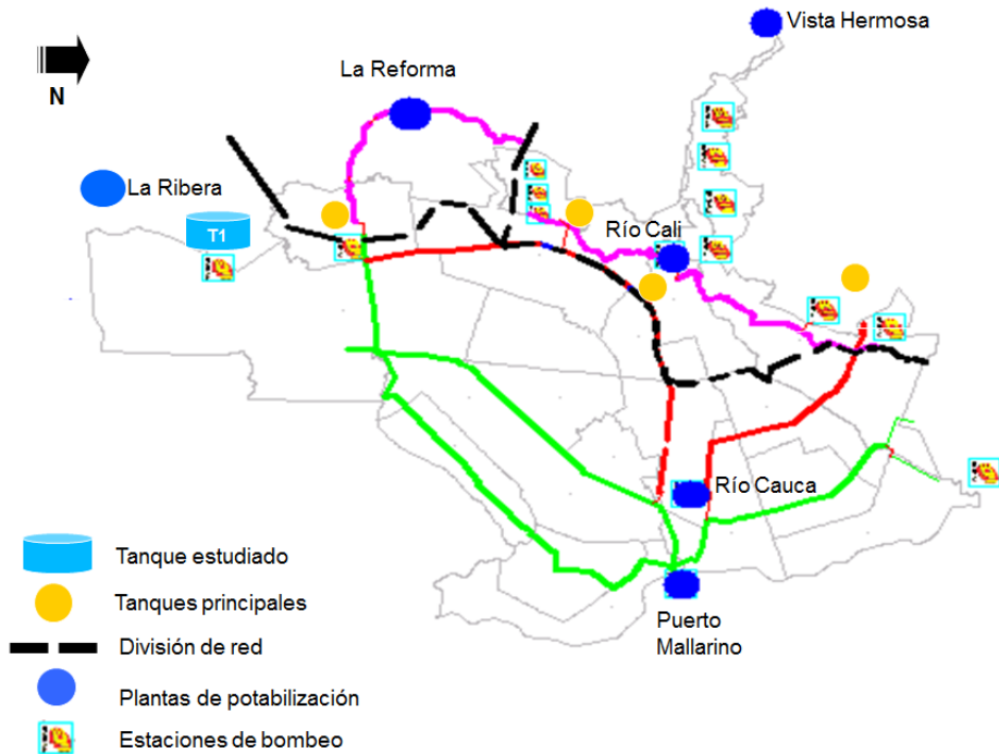
Figura 1: Ubicación de T1 en el sistema de distribución de agua potable de la ciudad de Cali.
