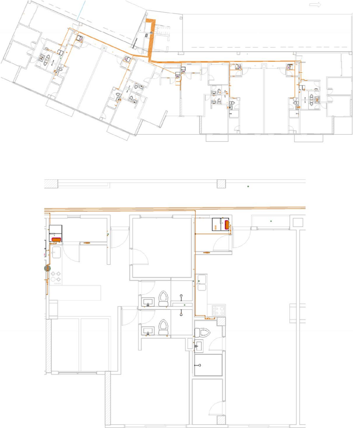
Ilustración 69. Plano en 2D de la red de gas de 2 apartamentos, modelado en Revit. Elaboración propia.
