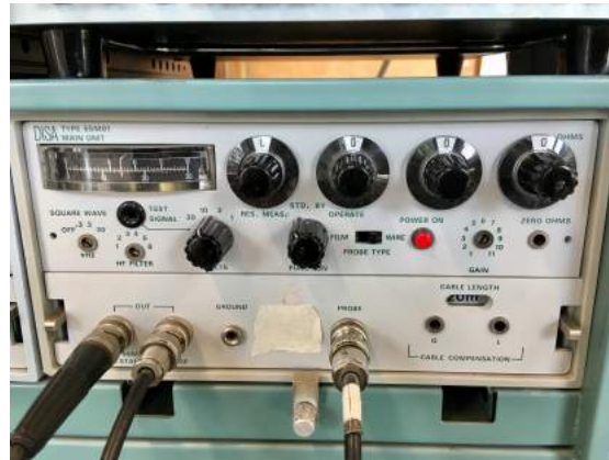
Figura 3.21: Anemómetro DISA Type 55M01 Utilizado en el experimento.
