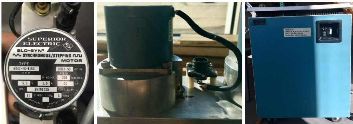
Figura 3.13: Motor, anclaje y caja de control de la malla activa.
