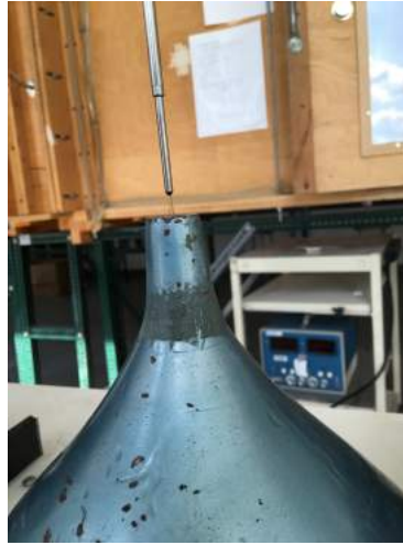
Figura 3.33: Sensor en U ubicado en la boca del embudo para calibrar.
