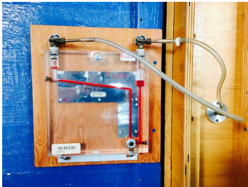
Figura 3.6: Pánel de lectura del sistema Pitot estático.
