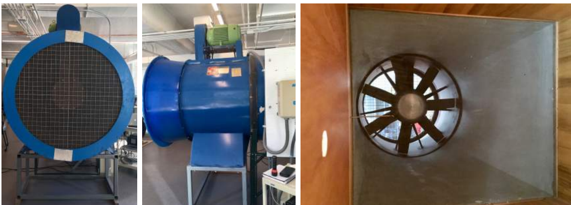
Figura 3.4: Motor y ventilador del túnel de viento vistos desde el exterior y el interior.
