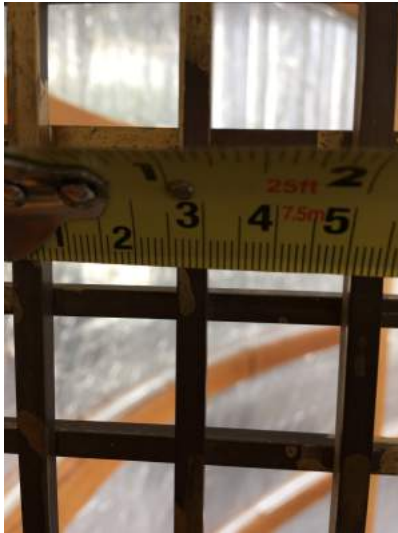
Figura 3.10: Malla pasiva M=0.026 m.
