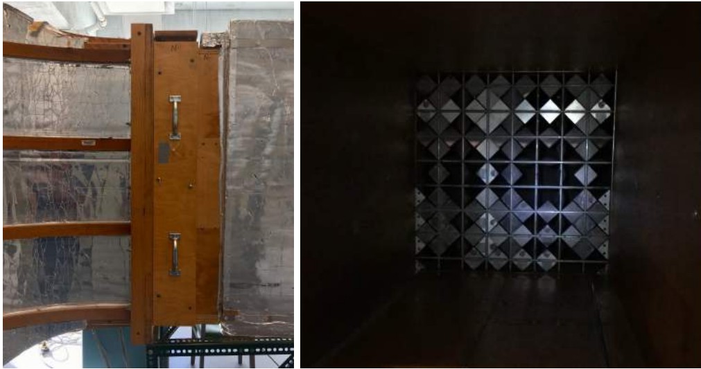
Figura 3.8: Zona de mallas en el tunel de viento (Exterior e Interior).
