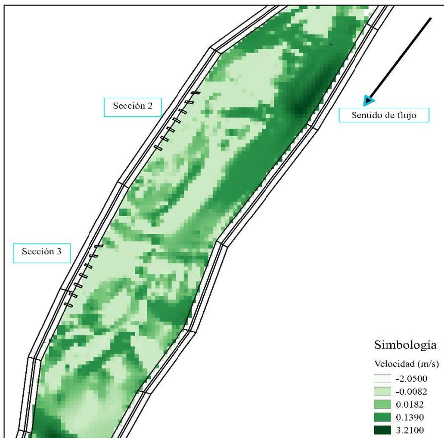
**Figura 4.29** Diferencia de raster de velocidades generado sin espigones y con espigones
