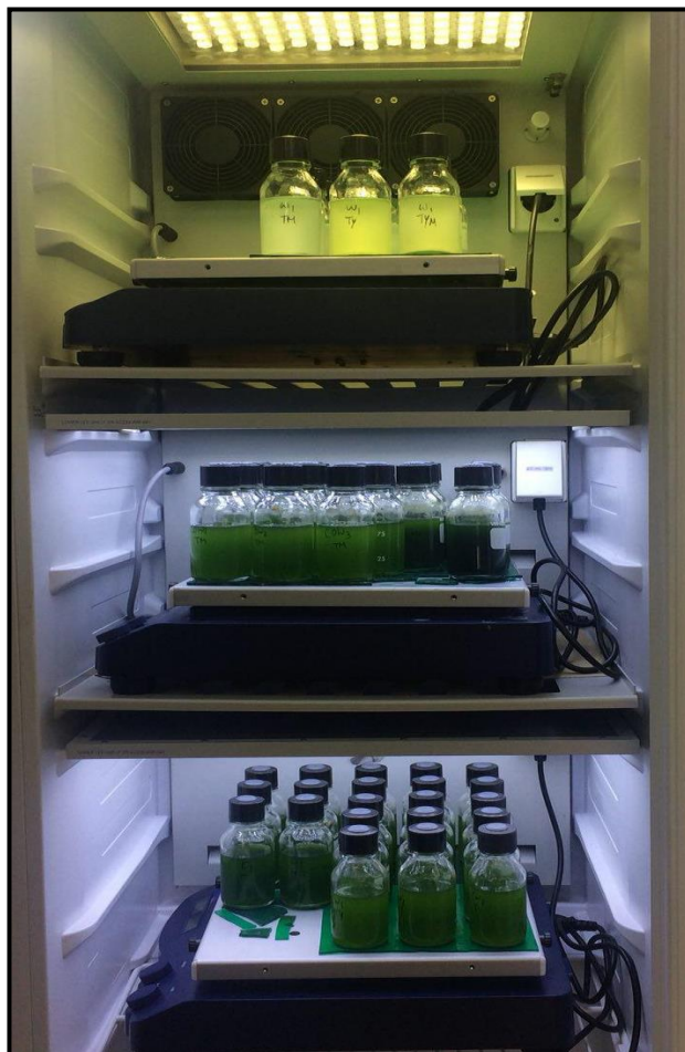
شکل ۳-۵. نمایی از سامانه‌ی آزمایشگاهی طراحی شده برای تولید هیدروژن.
