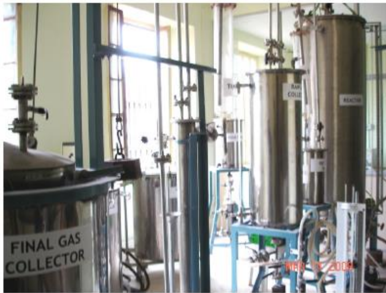
شکل پ ۳-۷. تصویر تولید نیمه صنعتی تخمیر هیدروژن در غیاب نور [۱۳۱].
