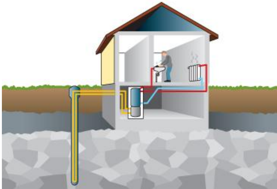
Figura 21: Calefacción geotérmica (Designoutlet, 2016).
