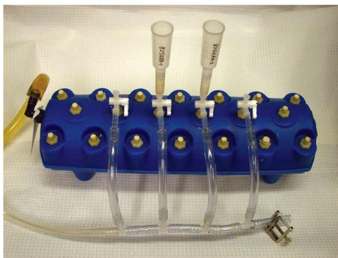
**Figura 13:** Imagen del equipo empleado para la síntesis manual de péptidos en fase sólida.
