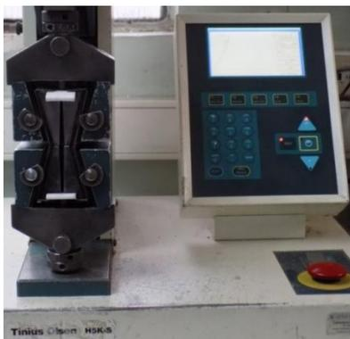
Fig.5: Máquina de ensayo universal Tinius Olsen® modelo H5HK-S
