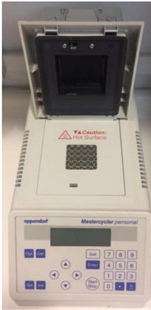
Fig.6 :Máquina de termociclado Mastercycler® Personal Eppendorf
