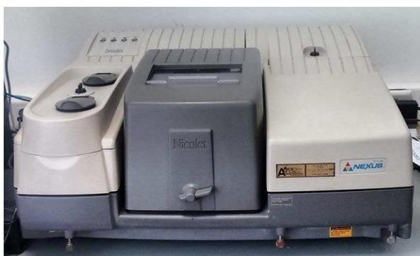
Imagen 15: Espectrofotómetro Infrarrojo
