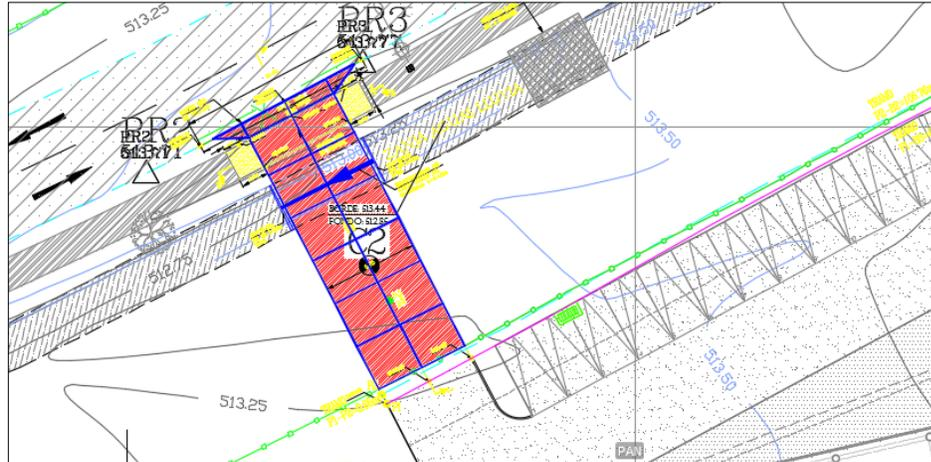
**Figura 4.11:** Acceso con módulos de hormigón prefabricado. Proyecto Centro Comercial Los Abedules, acceso C2
