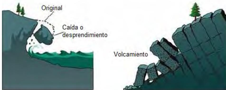
Figura 1-2 Desprendimientos de caída libre o falla por volcamiento. (Modificado de Grupo de geotecnia (2009), Universidad Católica de Valparaíso (UCV))
