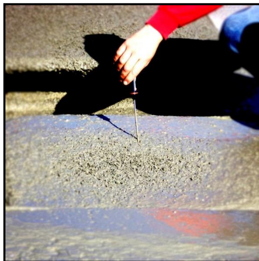
Imagen 3.8 Fotografía de medición de temperatura
