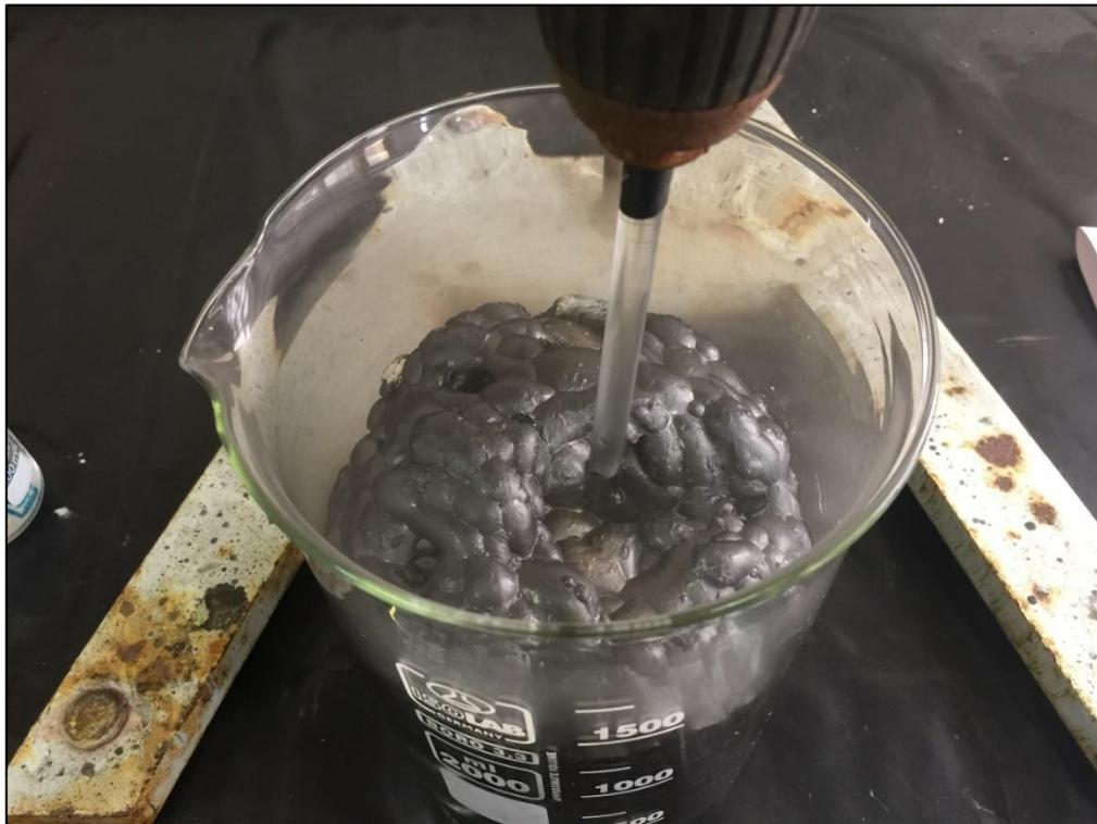
*Imagen 16: Efecto del arrastre de reactivos de flotación en la lixiviación de concentrados de cobre*
