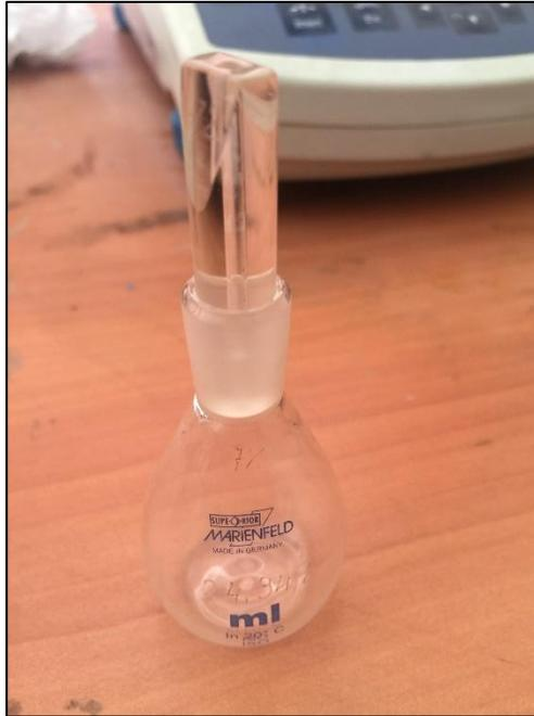
*Imagen 11: Picnómetro en prueba de densidad real.*
