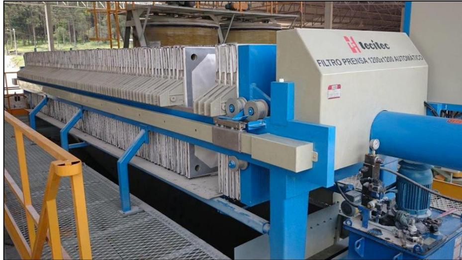
*Imagen 9: Filtro de prensa automático, marca Tecitec*
