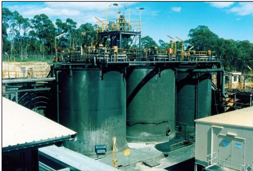
*Imagen 8: Planta de biolixiviación por agitación mediante el Proceso BIOX de la empresa Bacox, Tasmania, Australia*
