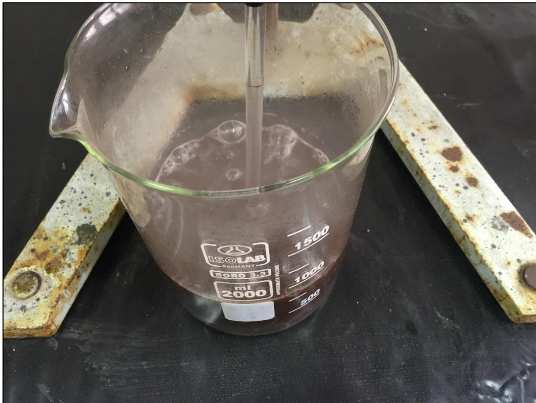
*Imagen 18: Lixiviación de la calcina de tostación*
