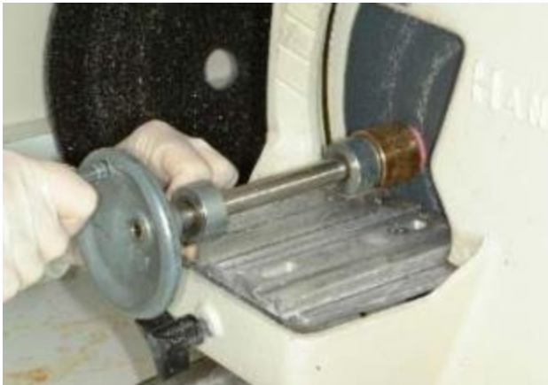
Figura 9: Desgaste de superficie superior y fondo del cilindro de acrílico con las muestras incluidas. (Fuente: propia)
