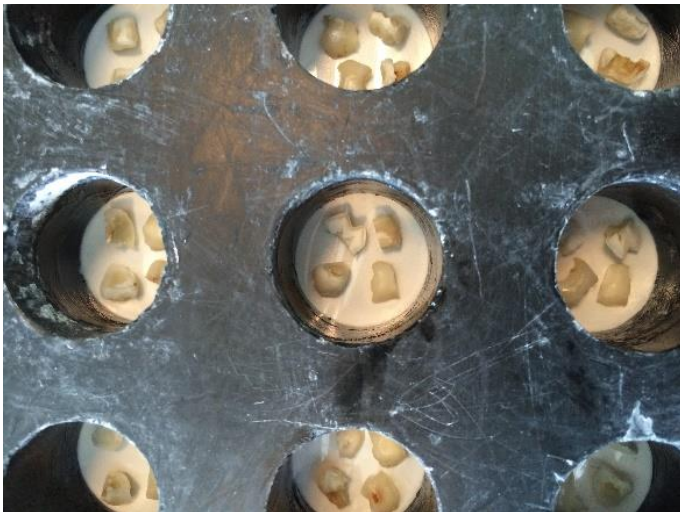
Figura 8: Se observa el posicionamiento de las muestras dentro de los cilindros del molde de inclusión, con la superficie de prueba pegada a la cinta adhesiva hacia el fondo del molde. (Fuente: propia)
