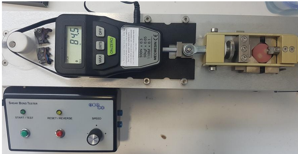
Figura 10. Prueba de resistencia al microcizallamiento en máquina Shear Bond Tester de BISCO.
