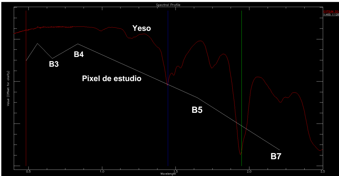
Figura 24. Análisis entre la firma espectral del pixel del punto de estudio A y la firma espectral del yeso obtenido de la librería espectral jpl1. Coordenadas: UTM WGS84 (19H) 636135-7369555. Imagen Landsat 7 ETM+. Fuente: ENVI Classic 5.3.
