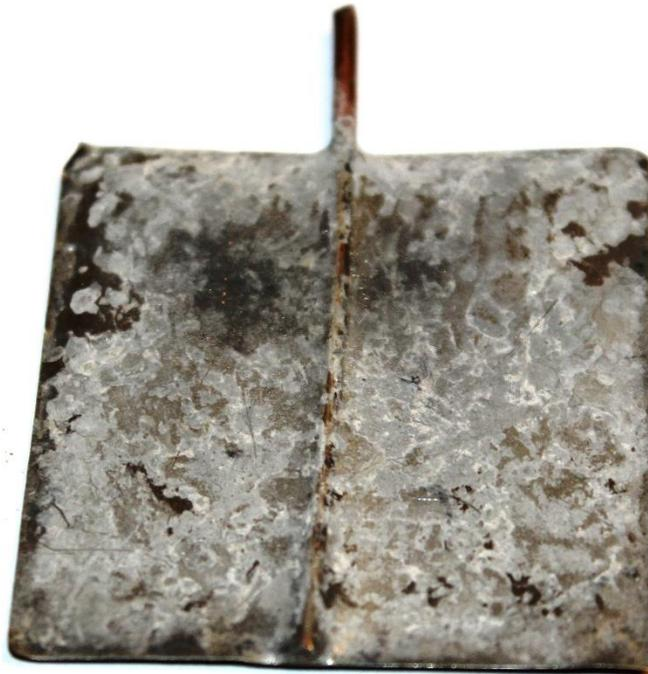
**Figura 3. Capa aislante producida por la lechada en los electrodos de cobre**
