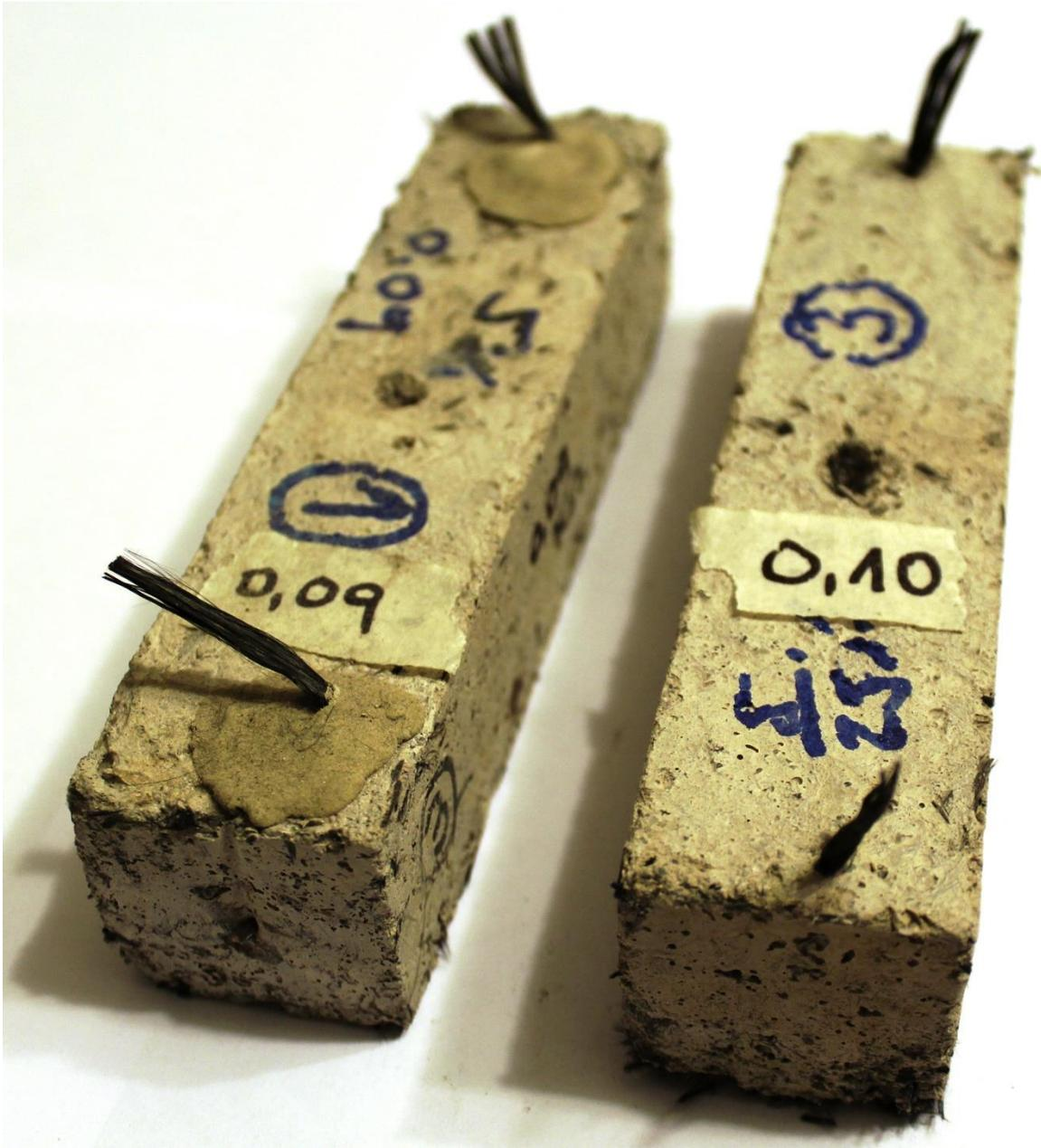
Figura 12. Ejemplo de probetas con 5% de adición de fibras de carbono. A la derecha variante con cuarzo y a la izquierda la que incorpora solamente fibras de carbono
