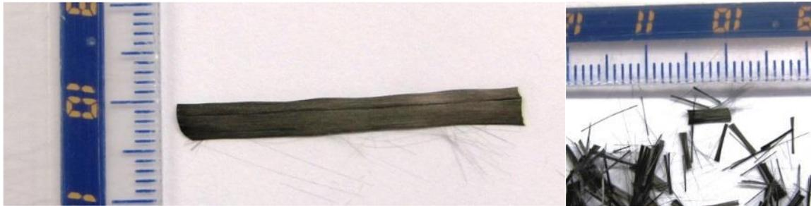
Figura 5. Fibra cortada para ser utilizada en la mezcla de mortero
