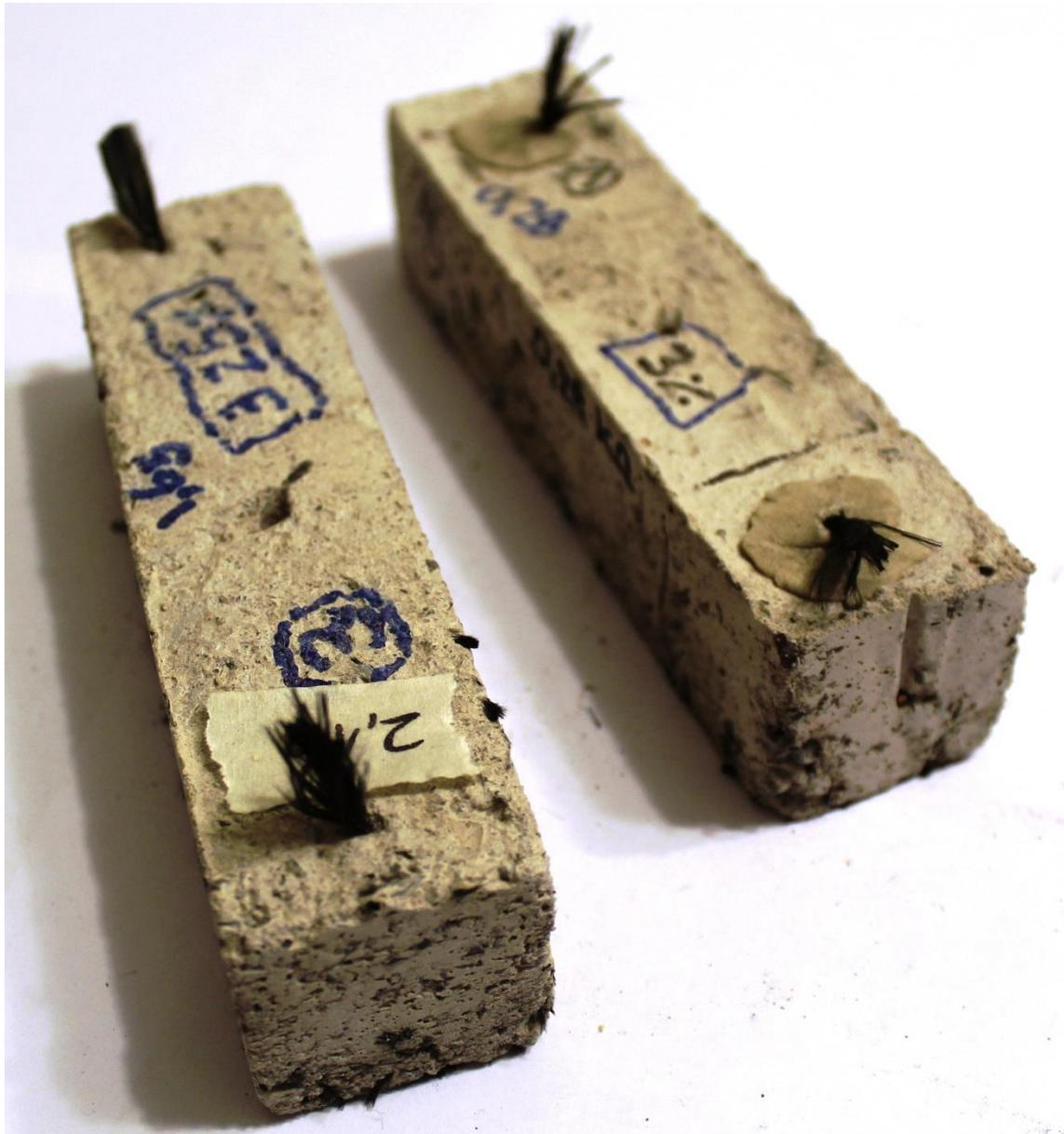
Figura 10. Ejemplo de probetas con 3% de adición de fibras de carbono. A la izquierda variante con cuarzo y a la derecha la que incorpora solamente fibras de carbono
