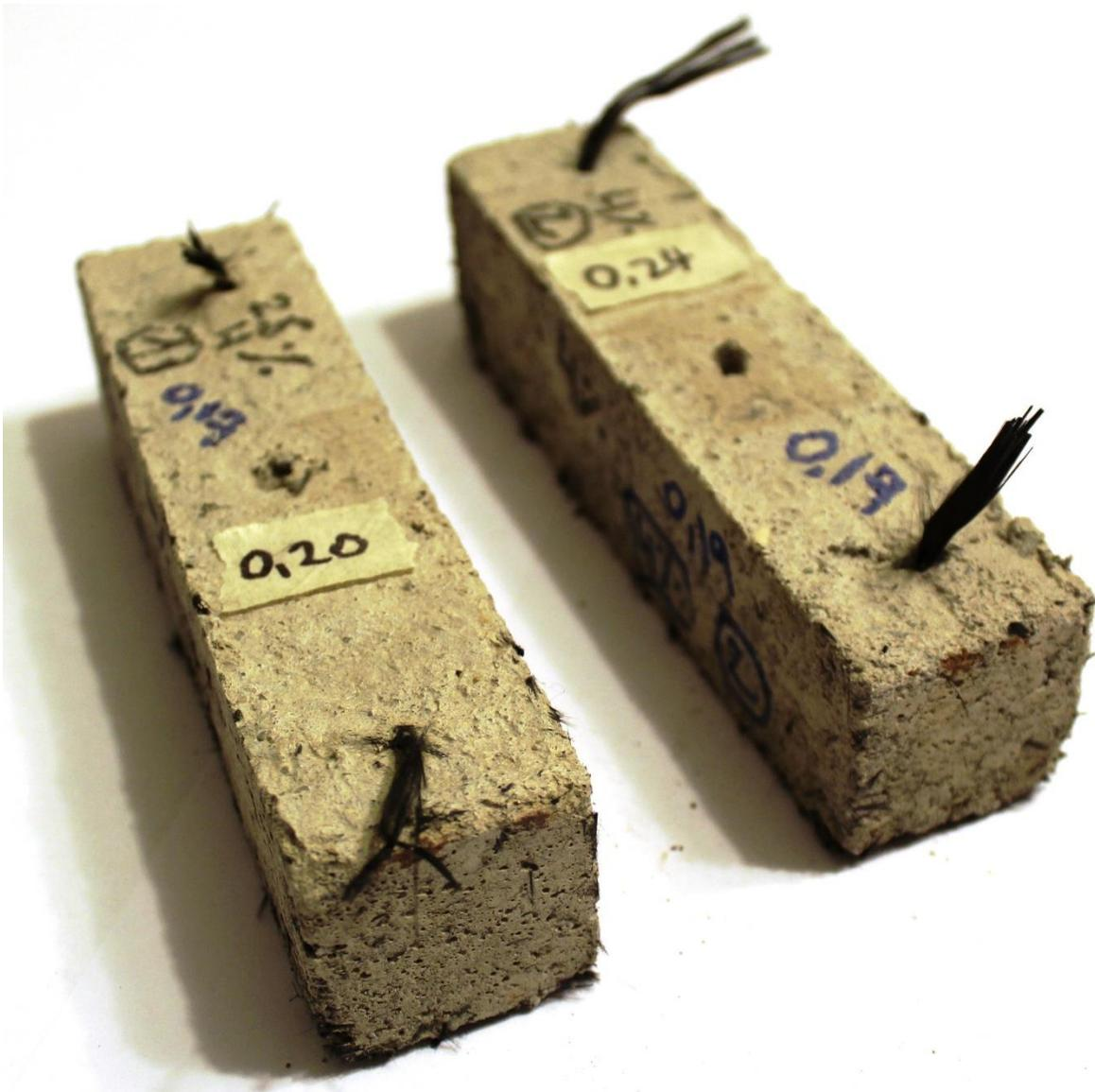
Figura 11. Ejemplo de probetas con 4% de adición de fibras de carbono. A la izquierda variante con cuarzo y a la derecha la que incorpora solamente fibras de carbono
