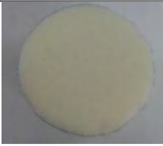
Espuma de poliuretano densidad 30, Espumatex.
