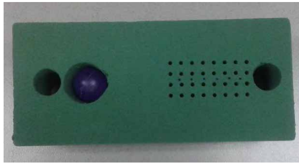
FIGURA 5.1 Prototipo de fantoma 1, con alineación del eje x e y pero no cumple con elementos de alineación en eje z (eje de movimiento de plano axial).
