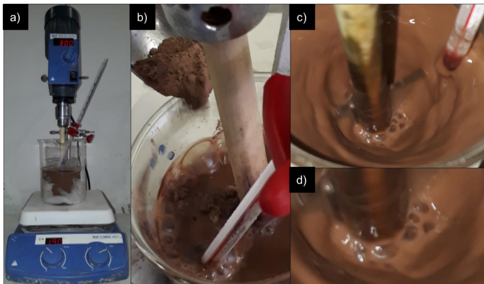
Figura 7.13 Sistema de lixiviación de calcinas utilizado en el procedimiento experimental
