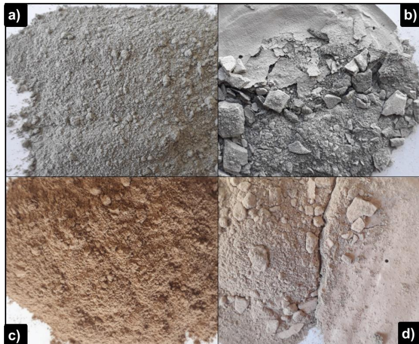
Figura 7.15 Cuadro sólidos: a) Relave seco, b) Remanente sólido de lixiviación de relave seco, c) Calcina de relave seco, d) Remanente sólido de lixiviación de calcina.
