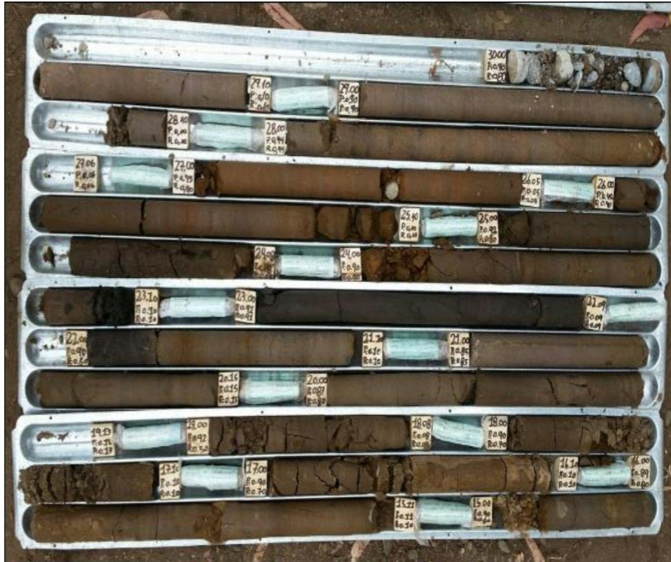
Ilustración 36: Muestras extraídas entre los 30.0m y los 15.0m de profundidad. Ed. Cons. Sto. Domingo.
