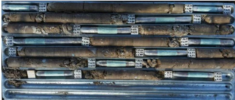
Ilustración 30: Muestras extraídas entre los 12.0m y los 30.0m de profundidad. Parque ENEA
