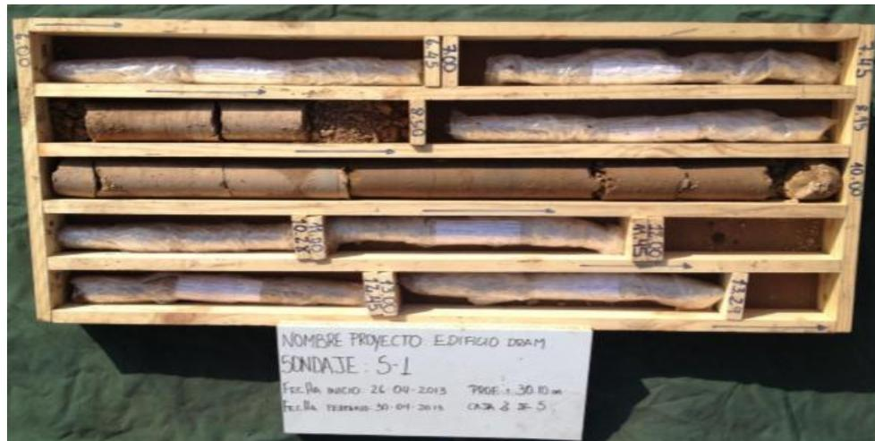
Ilustración 20: Muestras extraídas entre los 6.0m y los 13.3m de profundidad. Edificio DRAM
