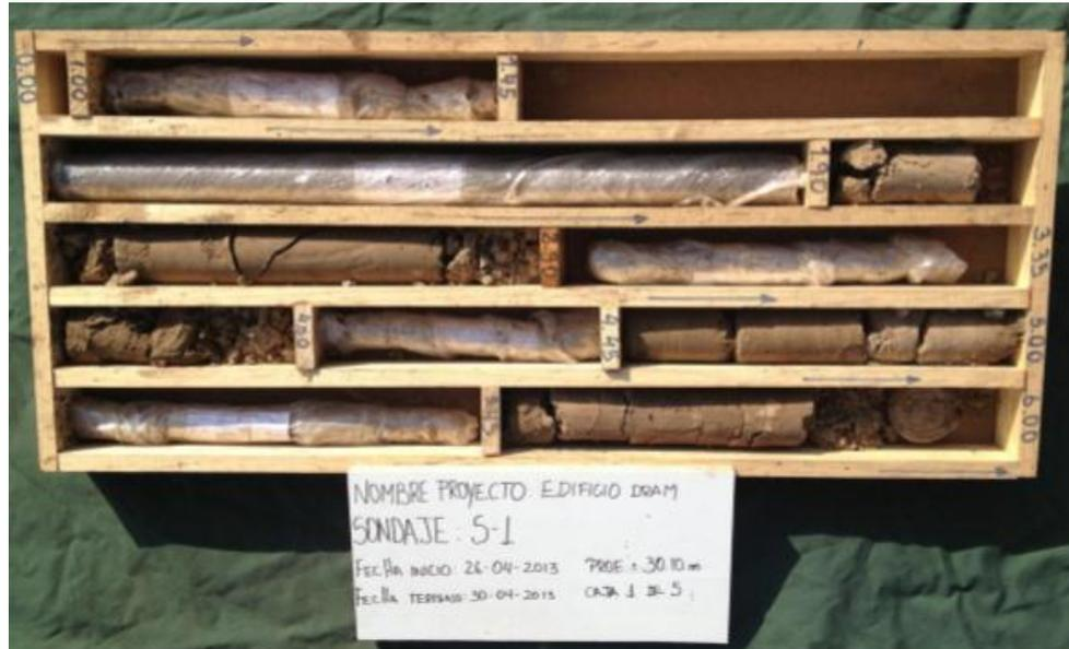
Ilustración 19: Muestras extraídas entre los 0.0m y los 6.0m de profundidad. Edificio DRAM
