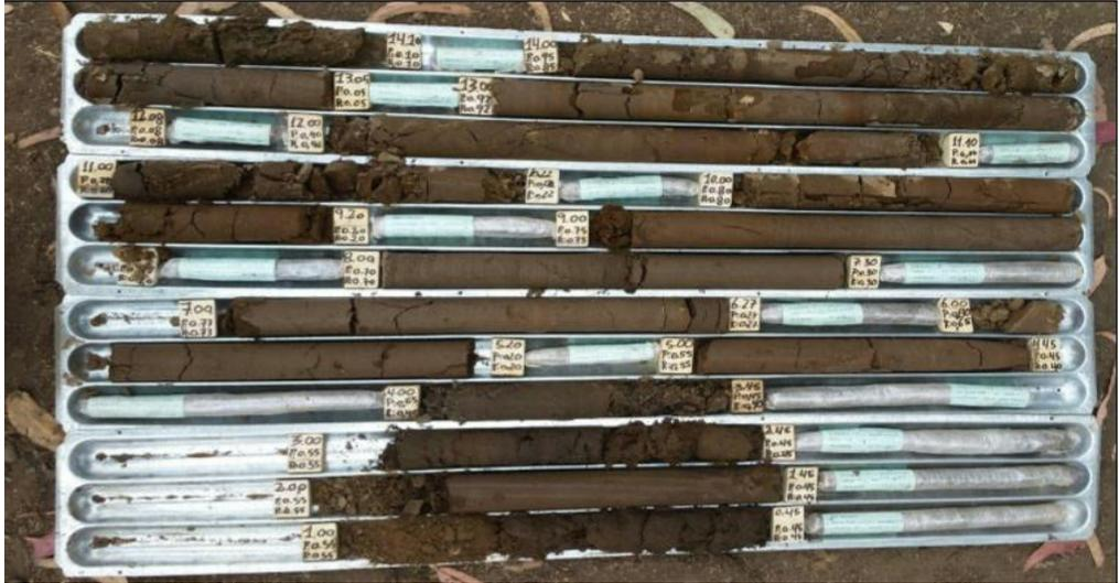
Ilustración 37: Muestras extraídas entre los 0.0m y los 15.0m de profundidad. Ed. Cons. Sto. Domingo
