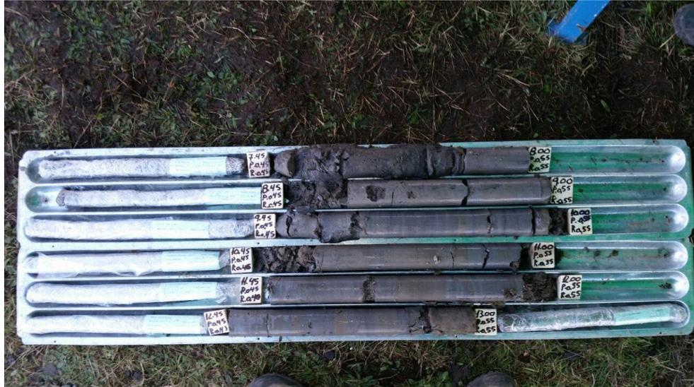
Ilustración 11: Muestras extraídas entre los 7.0m y los 13.0m de profundidad. Edificio Dos Esteros
