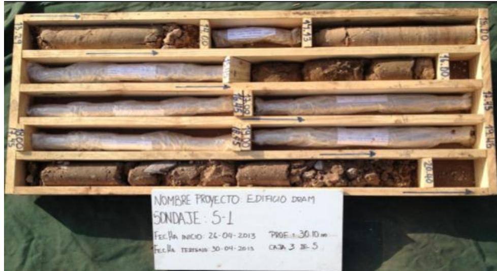
Ilustración 21: Muestras extraídas entre los 13.3m y los 20.4m de profundidad. Edificio DRAM
