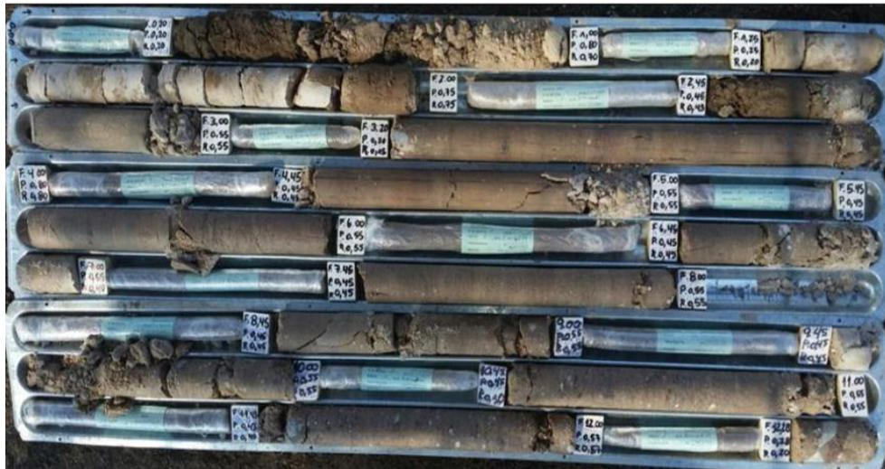
Ilustración 29: Muestras extraídas entre los 0.0m y los 12.0m de profundidad. Parque ENEA
