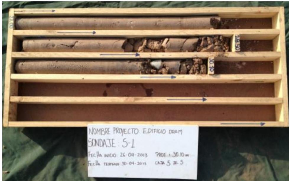
Ilustración 23: Muestras extraídas entre los 27.0m y los 30.0m de profundidad. Edificio DRAM
