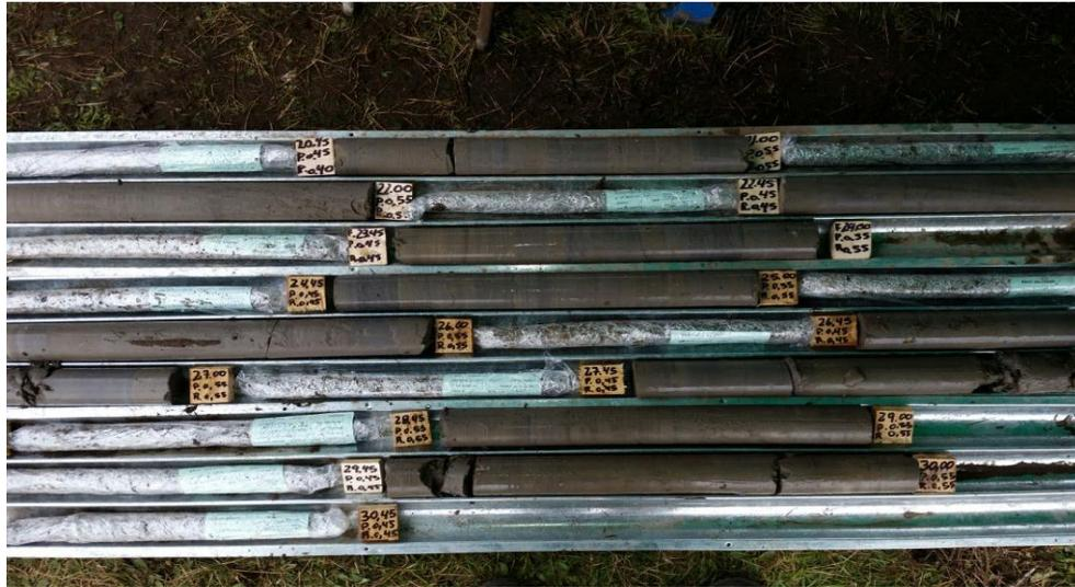
Ilustración 13: Muestras extraídas entre los 20.0m y los 30.0m de profundidad. Edificio Dos Esteros
