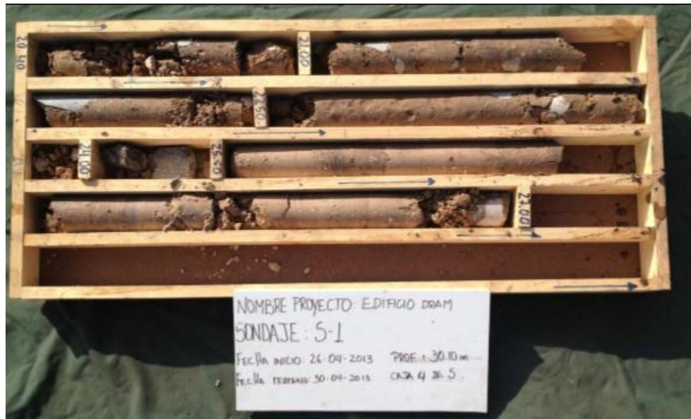
Ilustración 22: Muestras extraídas entre los 20.4m y los 27.0m de profundidad. Edificio DRAM
