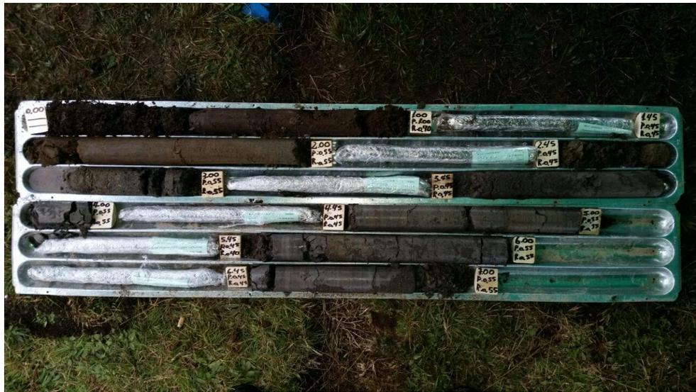
Ilustración 10: Muestras extraídas entre los 0.0m y los 7.0m de profundidad. Edificio Dos Esteros
