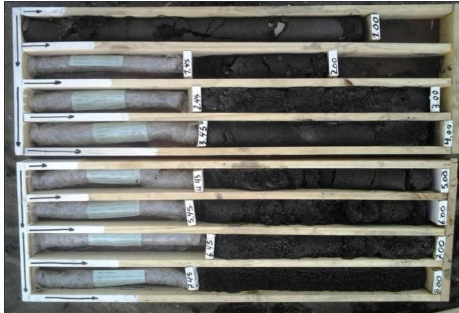
Ilustración 2: Muestras extraídas entre los 0.0m y los 8.0m de profundidad. Loma Colorada
