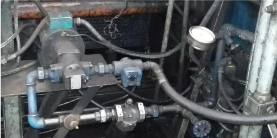
Ilustración 37. Líneas Sistema Lubricación por Aceite Grupo Cizalla
