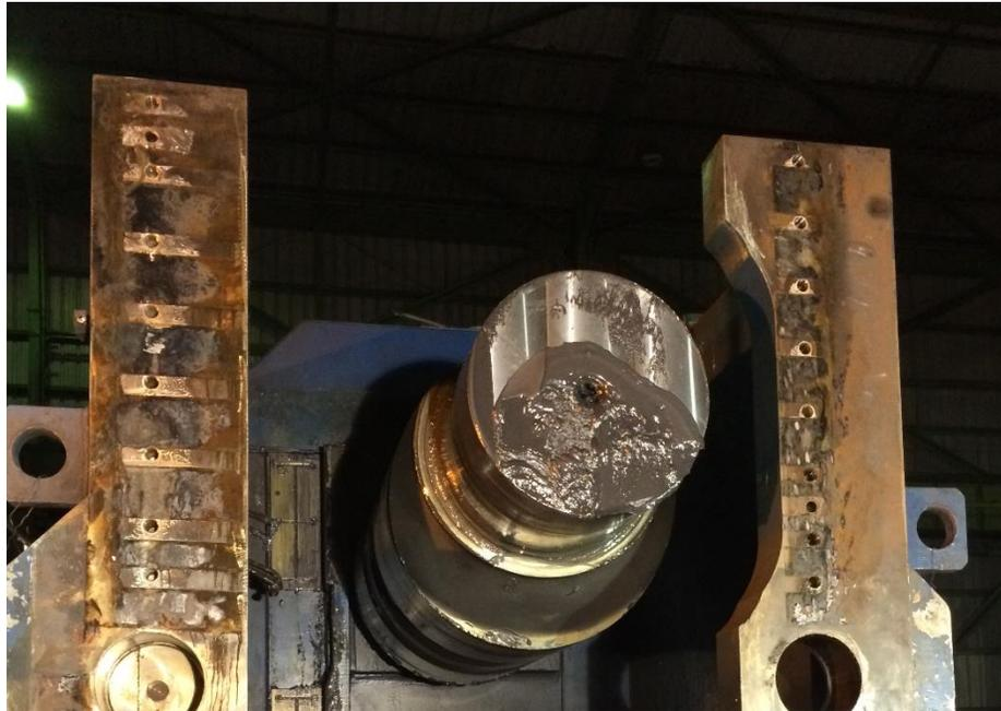
Ilustración 32. Eje Excéntrico Grupo Cizalla
