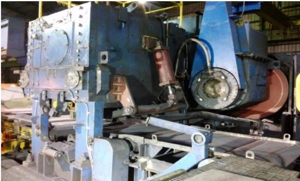
Ilustración 2. Guillotina de Corte Comercial
