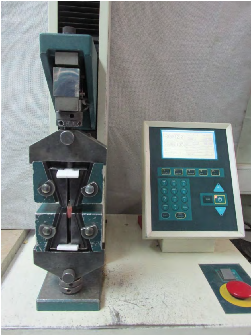
Imagen 1: Máquina de estudios universales Tinius Olsen, modelo H5K-S.
